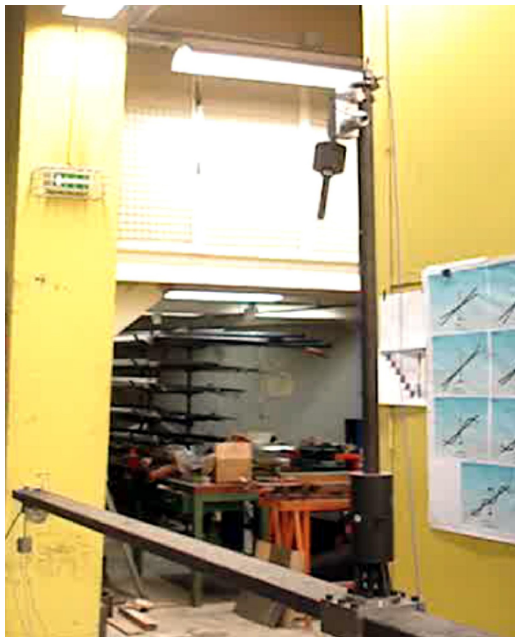
FIG. 6.19 – Contrôle du premier mode de vibration de la maquette du pont.
