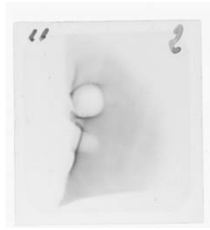
Figure 11.12: Double-Bulle observée lors de quelques tirs laser. Ici l'image protonique a été obtenue avec un gaz de N_2 à 50 \approx 28.8 ps après l'arrivée du faisceau laser principal sur la cible d'électrons (c.-à-d. ils sont produites par des protons avec une énergie de \approx 3.1 MeV).
