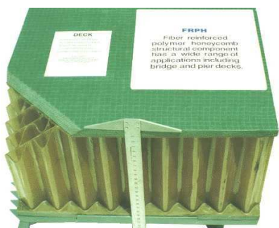
FIG. 1.6. Tablier en composite KSCI
