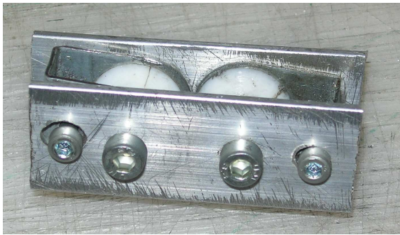
FIG. 4.12. Poulie double pour les nœuds libres
