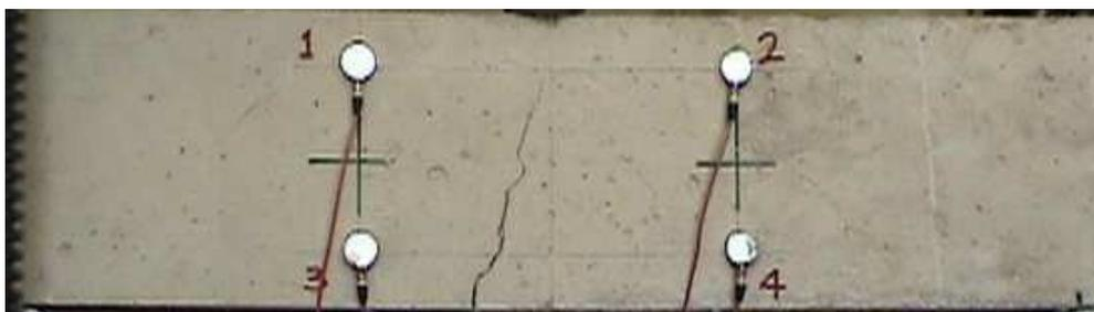
Figure 4-29 1<sup>er</sup> fissure de l'éprouvette « C9 » (1<sup>er</sup> cycle de chargement).
