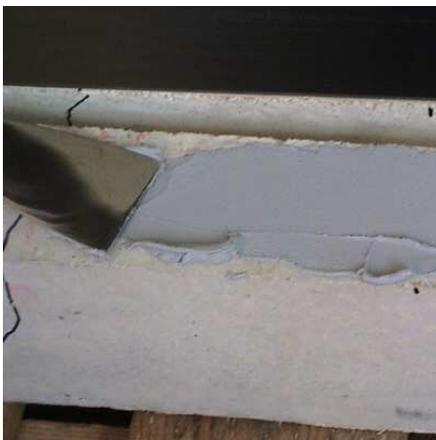
**Figure 4-2** Couche de RE appliquée sur la face tendue de l'éprouvette.
