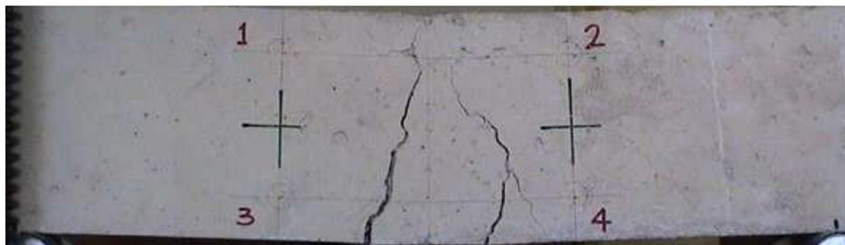
Figure 4-35 État final de l'éprouvette « C9 » (2<sup>ème</sup> cycle de chargement).
