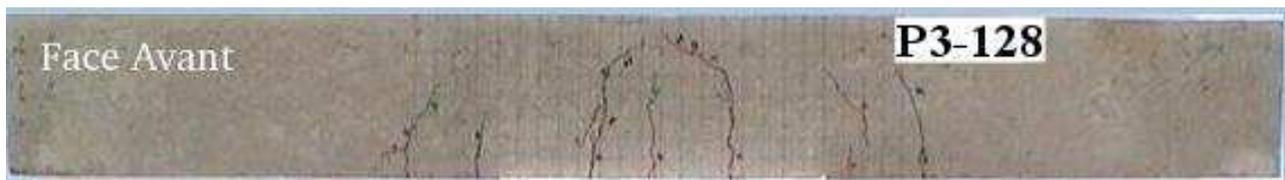
**Figure 3-17** Fissuration finale lors de l'essai de la poutre P3-128.
