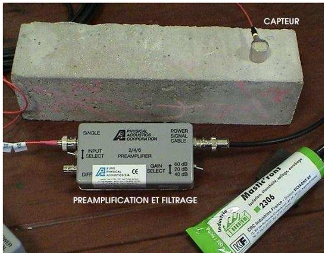
Figure 2-28 Capteur et préamplificateur de l'EA.
