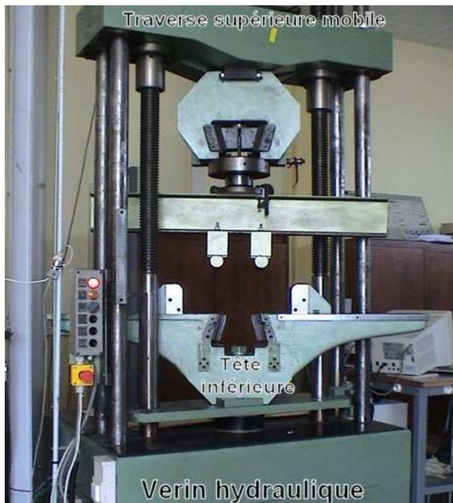
**Figure 2-19** Machine d'essai.
