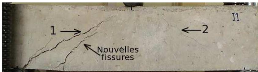
**Figure 4-10** Endommagement initial de la poutre « SF1-TC ».
