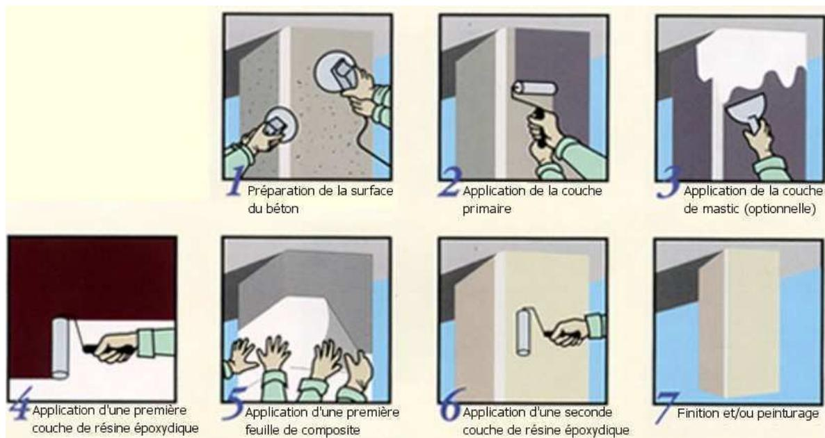
1. Préparation de la surface du béton [SIK\_06] : cette première étape est très importante pour assurer une bonne adhérence homogène entre le béton et le tissu. Elle consiste à préparer le support par sablage ou ponçage. La surface du béton doit être propre, saine, sèche, exempte de laitance, de graisse, d'huile, de produit de cure, de particules non ou peu adhérentes, de tout revêtement de type peinture, etc.
