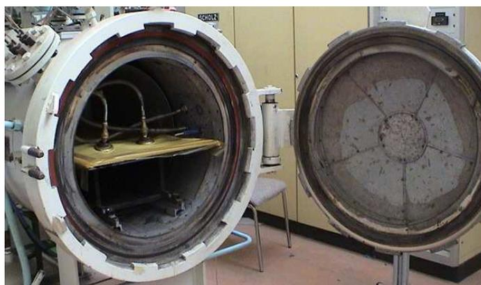
**Figure 2-9** Plaque en composite dans l'autoclave.
