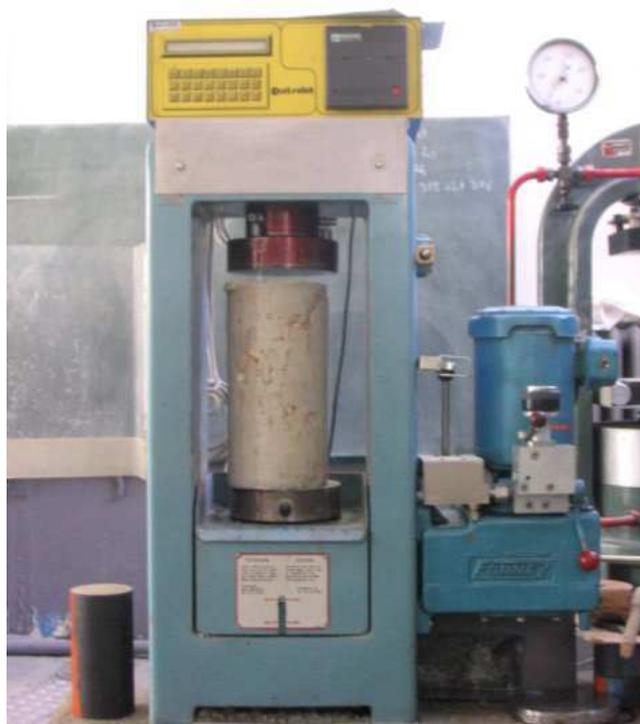
**Figure 2-18** Presse des essais de compression.
