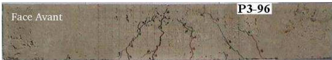
**Figure 3-13** Fissuration observée sur tous les côtés de P3-96.
