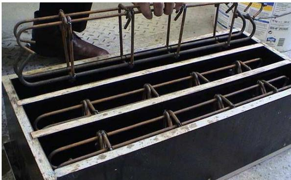
**Figure 2-5** Coffrage de 3 éprouvettes de 640mm de longueur.
