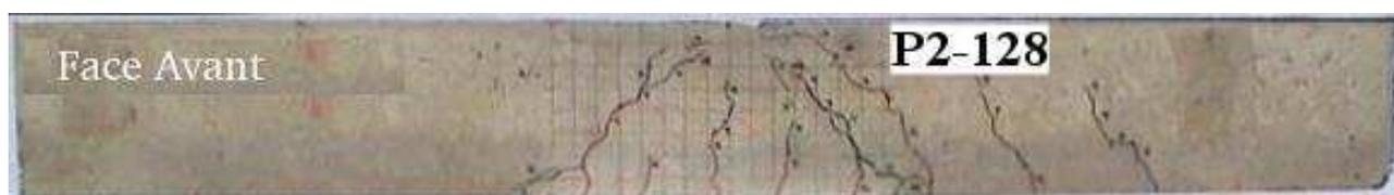
**Figure 3-16** Fissuration finale lors de l'essai de la poutre P2-128.
