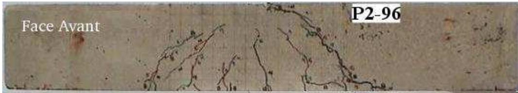
**Figure 3-12** Fissuration finale de l'éprouvette P2-96.
