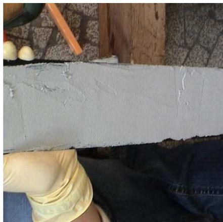
**Figure 4-3** Couche de RE sur la plaque en composite.
