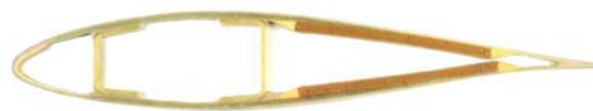
Figure A. 3 : Exemple d'une section de pale en résine polyester / fibre de verre (LM Glasfiber A/S)
