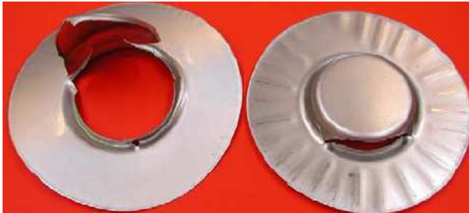
Figure 1.12. Rupture sans formation de plis (à gauche : effort de serrage élevé) et avec formation de plis (à droite : effort de serrage faible). D'après Lang et al. (2004).
