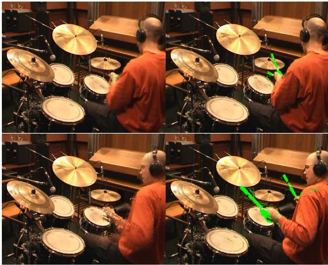
FIG. 7.10 – Segmentation des baguettes par segmentation de l'avant-plan en mouvement. Modèle de l'arrière-plan, et trame originale avec marquage coloré de l'avant-plan détecté
