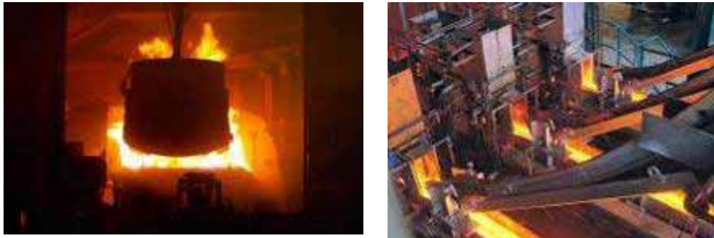
Obtención de acero en el Horno Eléctrico y Desbaste
