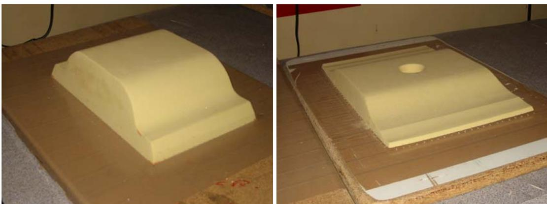
Figure 12. Moules en mousse pour thermoformage.
