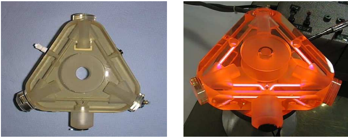
FIGURE 1 – Gyrolaser à hélium-néon monoaxe triangulaire, produit par Thales Aerospace. La photo de gauche représente le gyrolaser à l’arrêt, et celle de droite le gyrolaser en fonctionnement. La couleur rose est due à la fluorescence du néon vue à travers le Zerodur. Photos Thales Aerospace.
