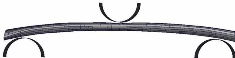
Figure 74. Appuis et impacteur cylindriques. La côte est posée en équilibre sur les appuis.
