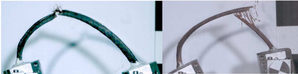
Photo 9. Illustration d'une rupture franche (à gauche) et d'une rupture oblique (à droite).
