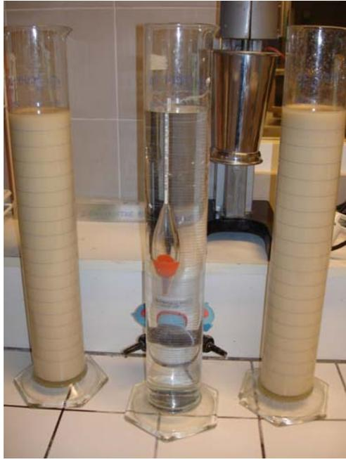
Figure V. 11: Essai de sédimentométrie sur la partie fine du matériau.
