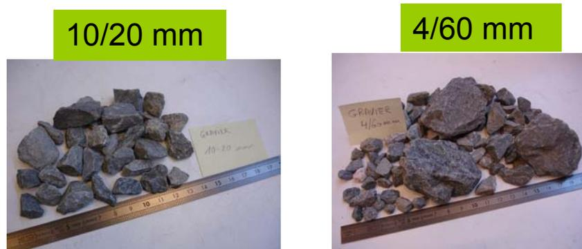
Figure II. 19: Vue des graviers utilisés
