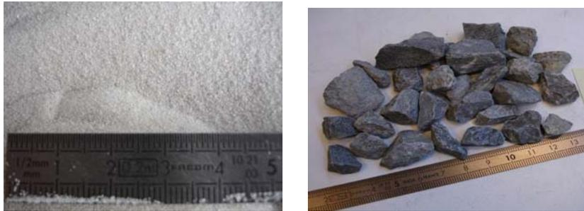
Figure II. 20: Matrice sableuse et inclusions (graviers anguleux)
