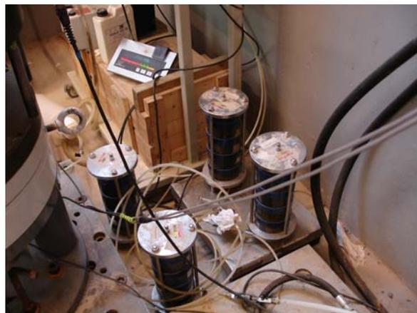
Figure II. 9: Cellules et balance permettant de mesurer les variations de volume de l'éprouvette
