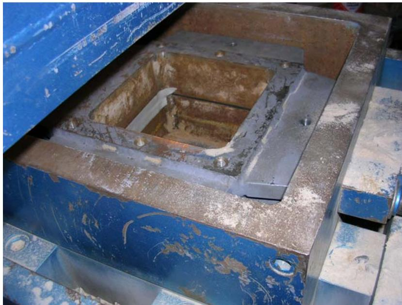
*Figure II. 14: Vue de la boîte de taille moyenne placée à l'intérieur de la grande boîte de cisaillement direct*
