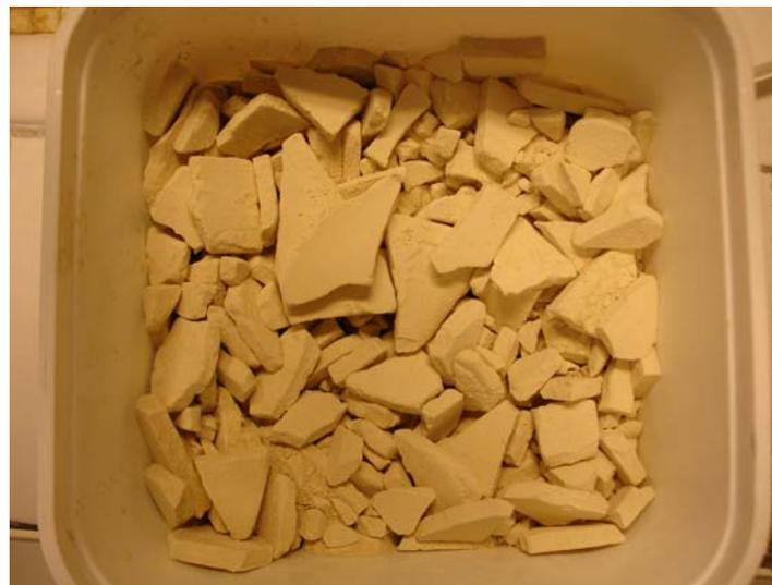
*Figure V. 10: Fraction des particules inférieures à 0,08 mm après séchage.*
