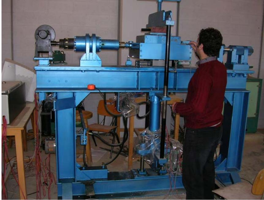
Figure II. 12: Vue générale de la boîte de cisaillement direct
