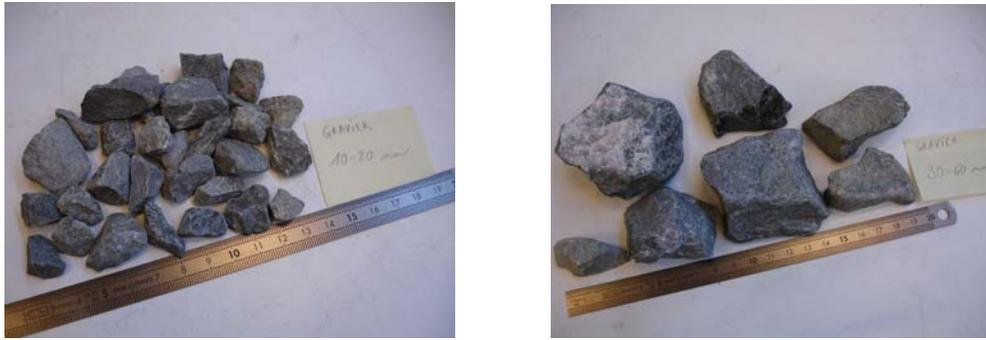
Figure III. 8: Vue des graviers utilisés dans l'étude relative à la taille des inclusions : (a) graviers 10/20 mm ; (b) graviers 30/60 mm.
