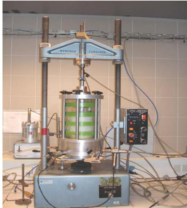
Figure II. 10: Vue de la cellule triaxiale Ø100 mm
