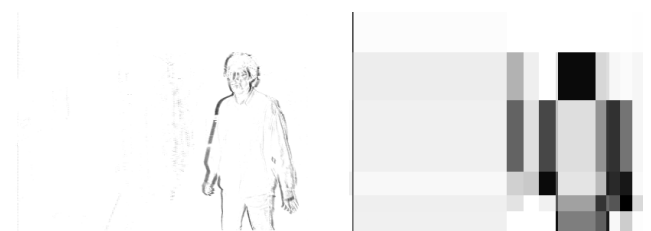
FIG. 3 – Détection de mouvement dans un flux vidéo : à gauche, image résultant de la différence entre deux trames successives ; à droite, segmentation en grille de cette image avec visualisation des zones de forte entropie
