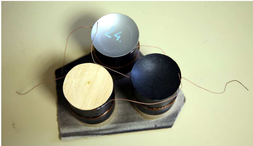
FIG. 9.3 – Photo de trois équipages mobiles différents. De gauche à droite : profil plan en balsa, profil concave en aluminium et profil concave en carton.
