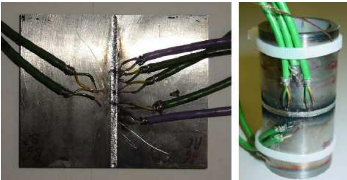
Figure 2-8 : Cordon de soudure par laser YAG impulsionnelle du TA6V
