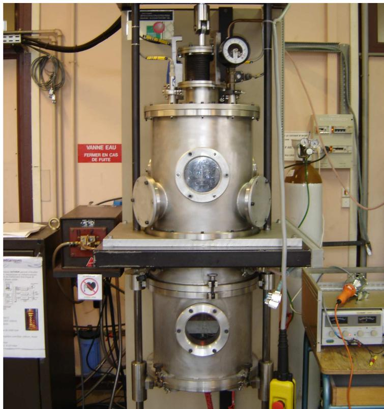
B - Machine électromécanique Mayes de capacité 100KN pour les essais sous atmosphère d'azote (essai traction / relaxation) jusqu'à 1020°C.
