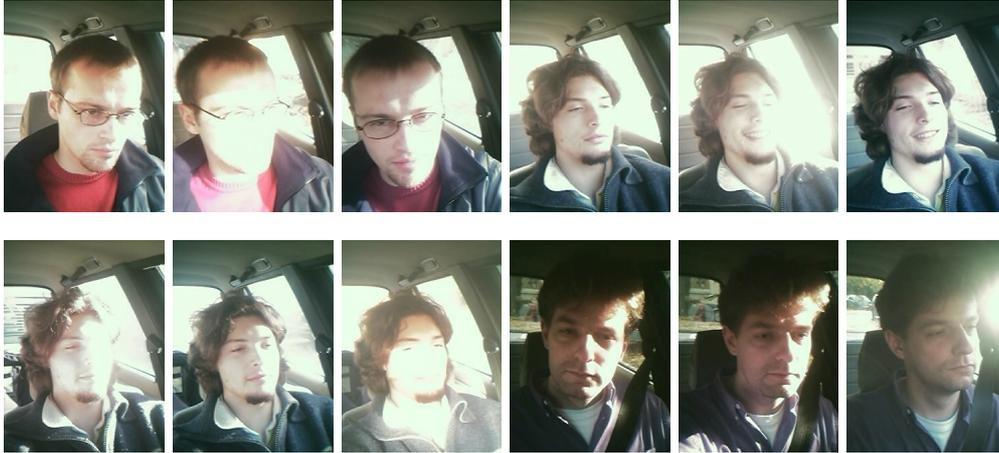
Fig. 1.2.: Extraits de la base d'acquisition « Logitech ». Cette base est un extrait de nos propres acquisitions à partir d'un système simple: une caméra de type Webcam est fixée sous le rétroviseur et orientée vers le conducteur.
