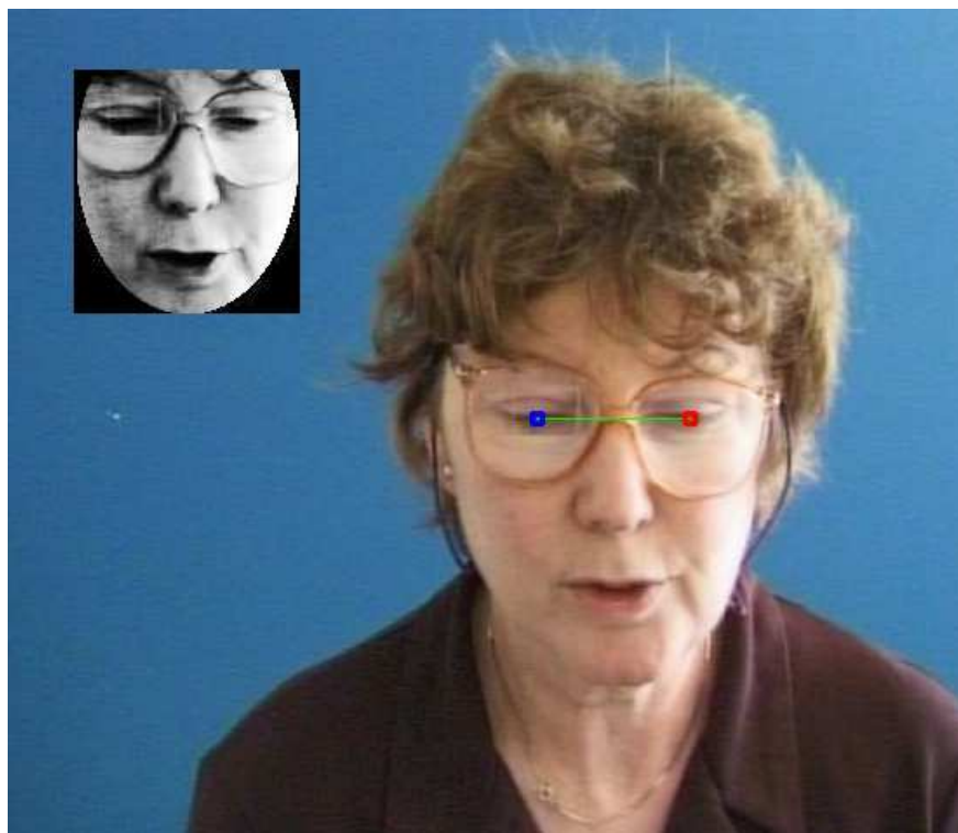
FIG. 3.7 – Normalisation du visage. Le visage est normalisé en fonction de la position des yeux détectés. Un masque ellipsoïde est ajouté afin de supprimer le fond.
