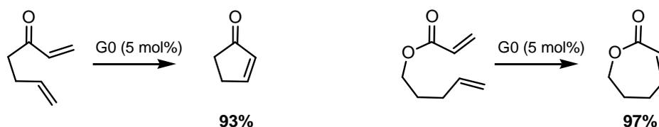
**Fig 191** Exemples de métathèses cyclisantes de vinylcétonne ou d'acrylate avec le catalyseur **G0**
