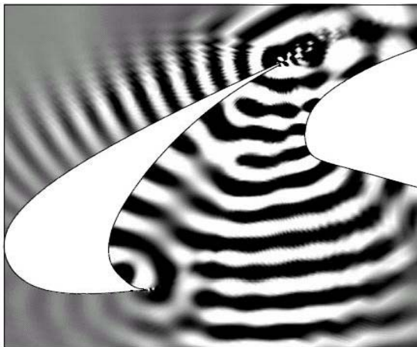
FIG. 1.6 – Fluctuation de la pression par calcul DNS dans un système hypersustentateur, NASA Langley Research Center.
