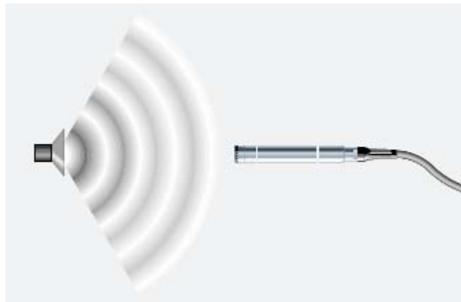
Fig. III-7- Microphone en champ libre et son application
