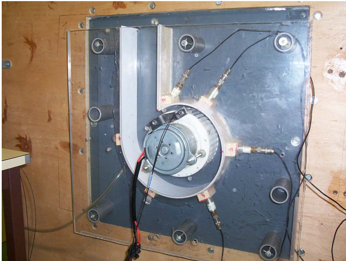
Fig. B-2. Montage des microphones de pression sur la surface de la volute
