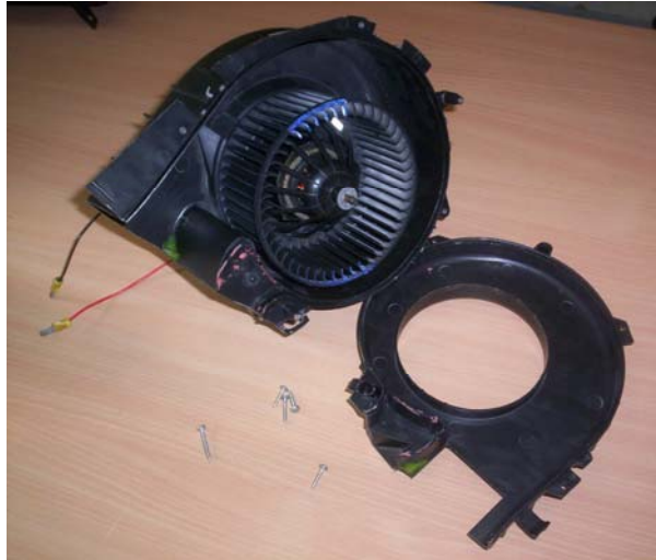
Fig. I-2. Ventilateur destiné à une application automobile
