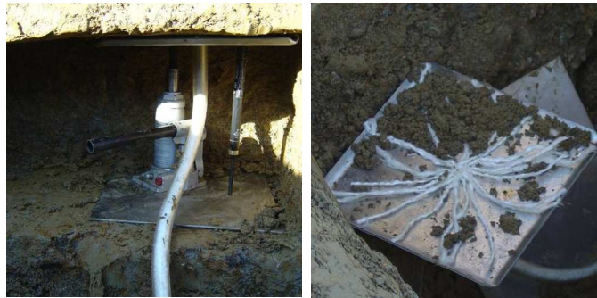
Figure 14. Photographies des lysimètres à mèche installés sur les modalités de la parcelle agricole.
