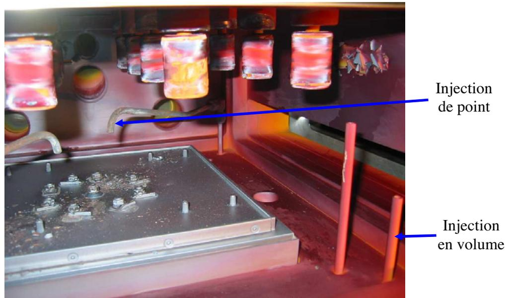
**Fig.10** Intérieur de la chambre de dépôt du réacteur Domex. La pompe turbo est placée à gauche de la photo
