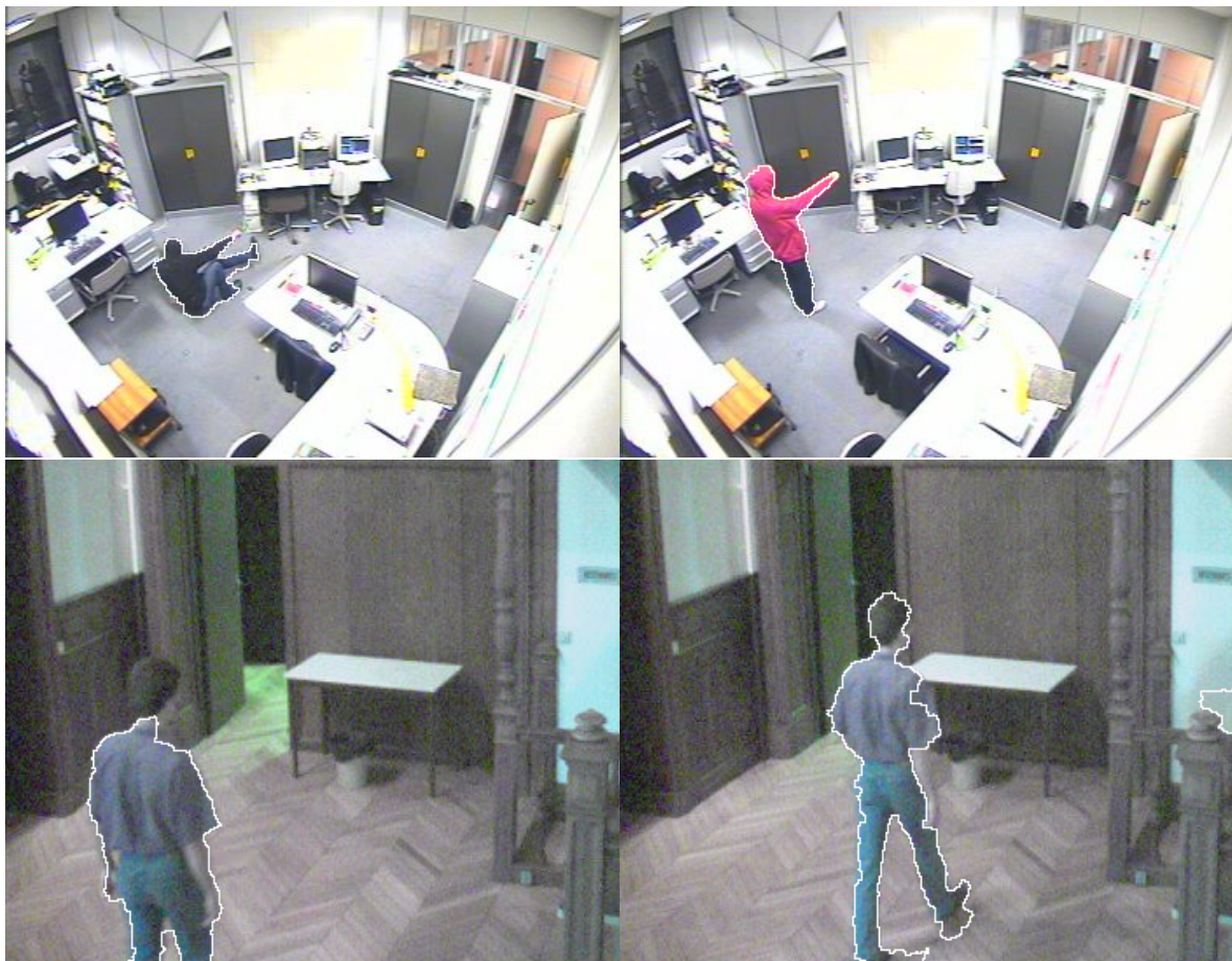
FIG. 9.10: Résultats : détection de la personne dans deux séries de séquences. La seconde série est plus difficile car l'éclairage est médiocre et l'image très bruitée.
