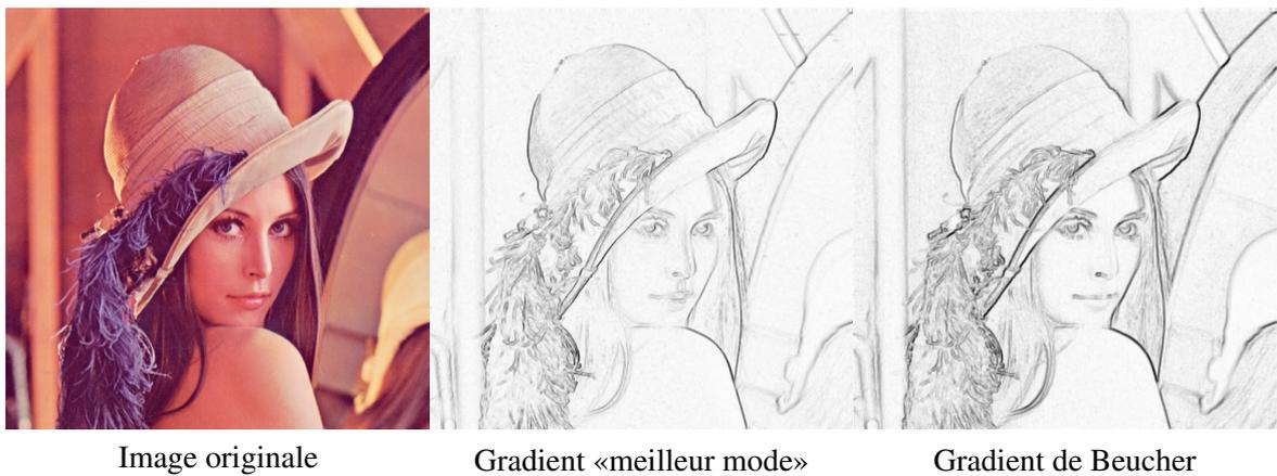
FIG. 5.12: Choix d'un gradient de référence : le gradient de Beucher sur la luminance offre le résultat le plus plaisant (test réalisé sur un panel de 3 personnes).
