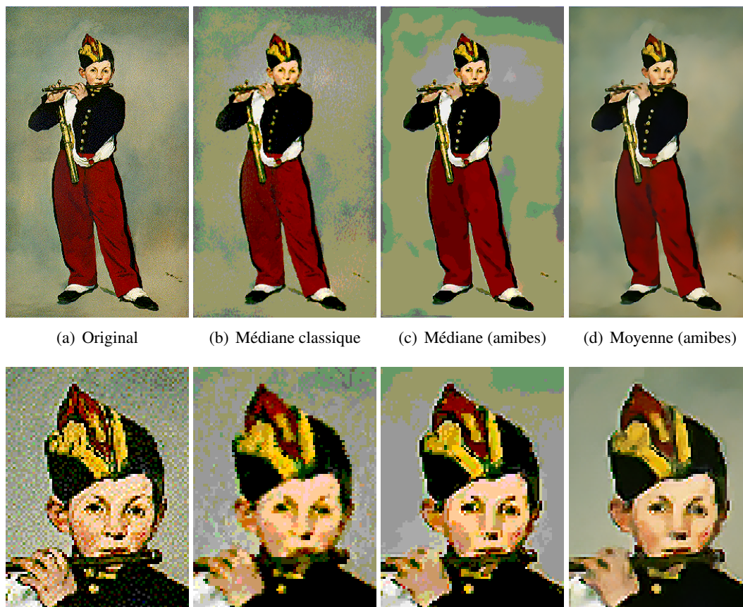
FIG. 4.14: Résultats d'un filtrage médian classique, et de deux filtrages basés sur des amibes : une médiane et une moyenne.
