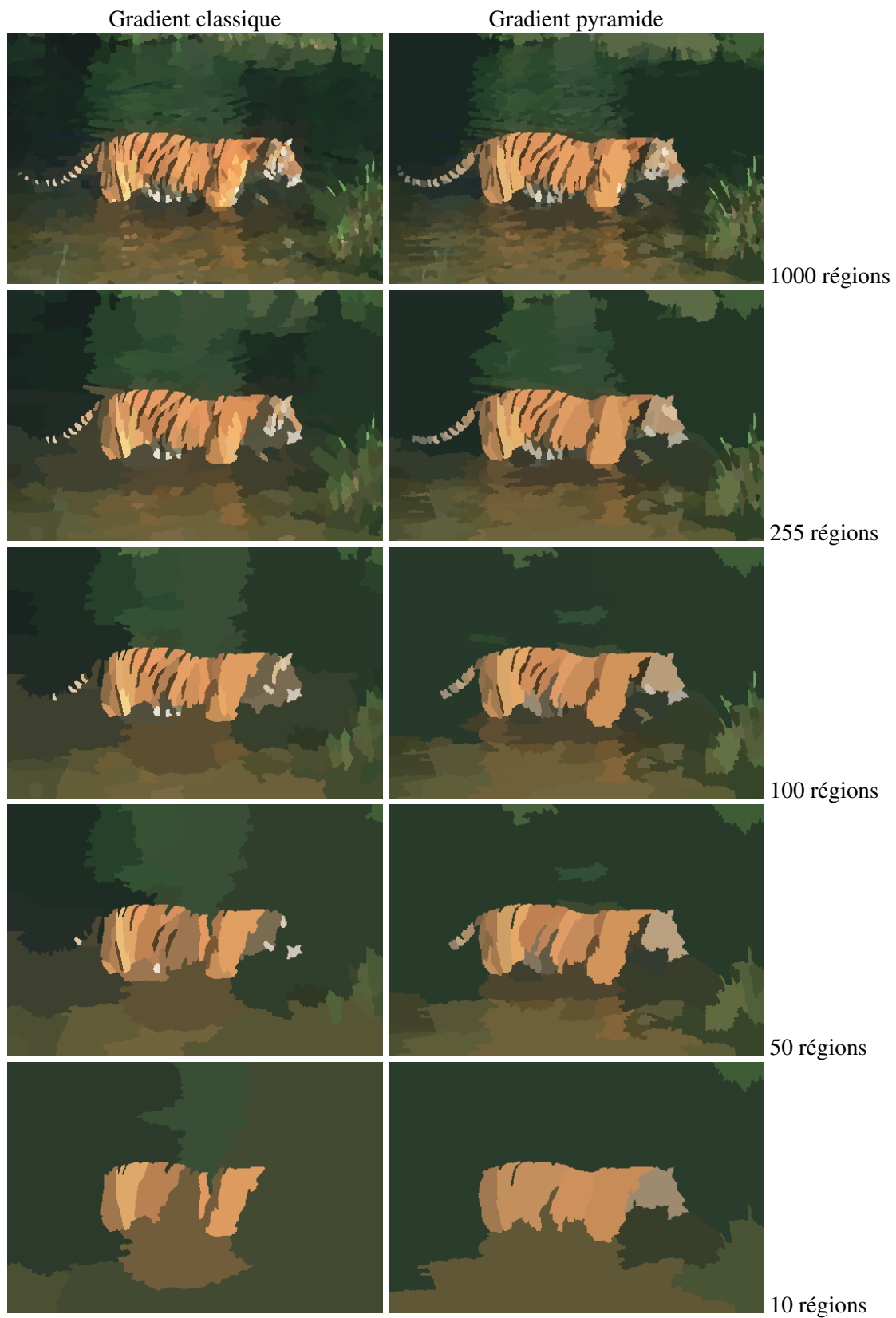
FIG. 6.17: Comparaisons entre la segmentation hiérarchique du gradient pyramide (à droite) et celle d'un gradient LAB classique (à gauche).
