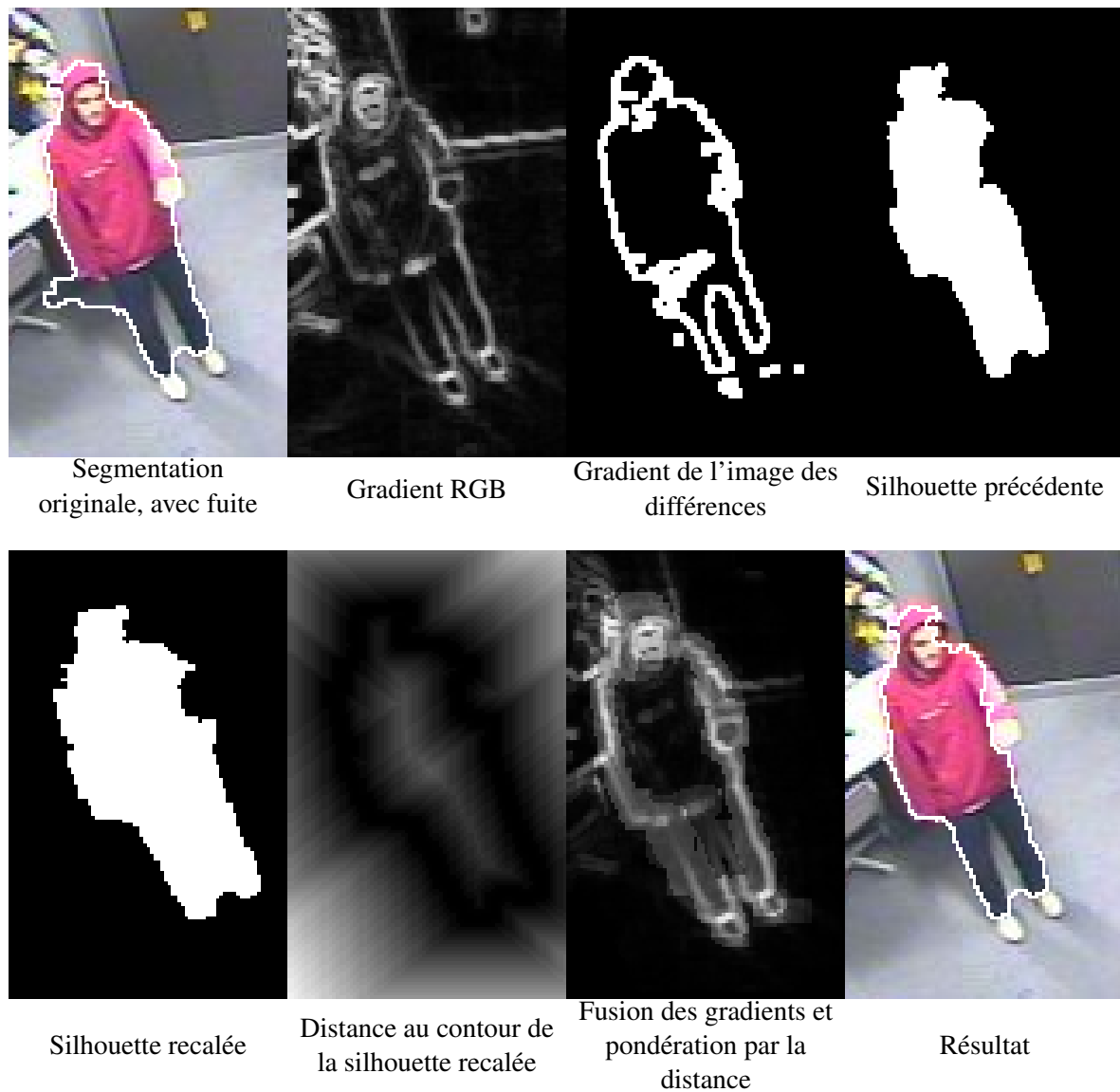
FIG. 9.14: Toutes les étapes d'amélioration du gradient avant l'inondation. L'utilisation du résultat précédent a permis d'éviter la fuite dans la zone d'ombre sous le bureau. En revanche, on a aussi propagé la mauvaise détection du bras gauche, perdu quelques trames auparavant.
