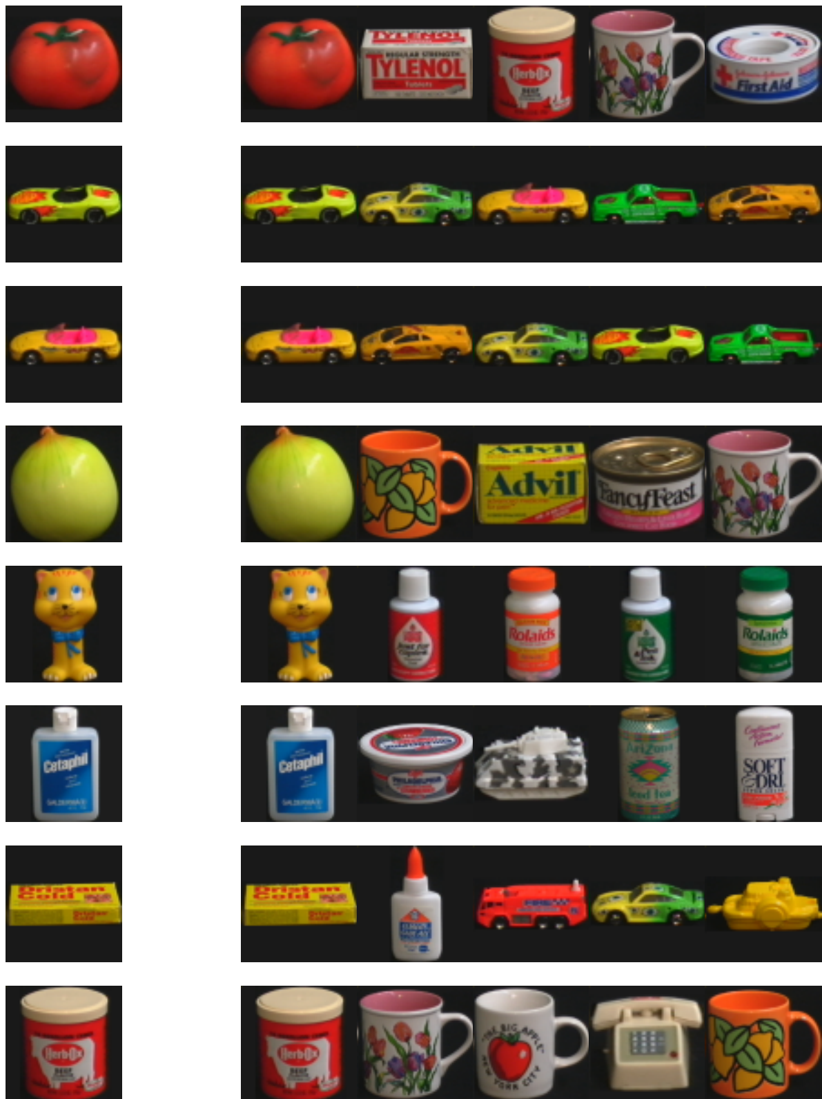
FIG. 7.3: Recherche d'images dans une base de données : algorithme traditionnel basé sur la comparaison d'histogrammes couleur.
