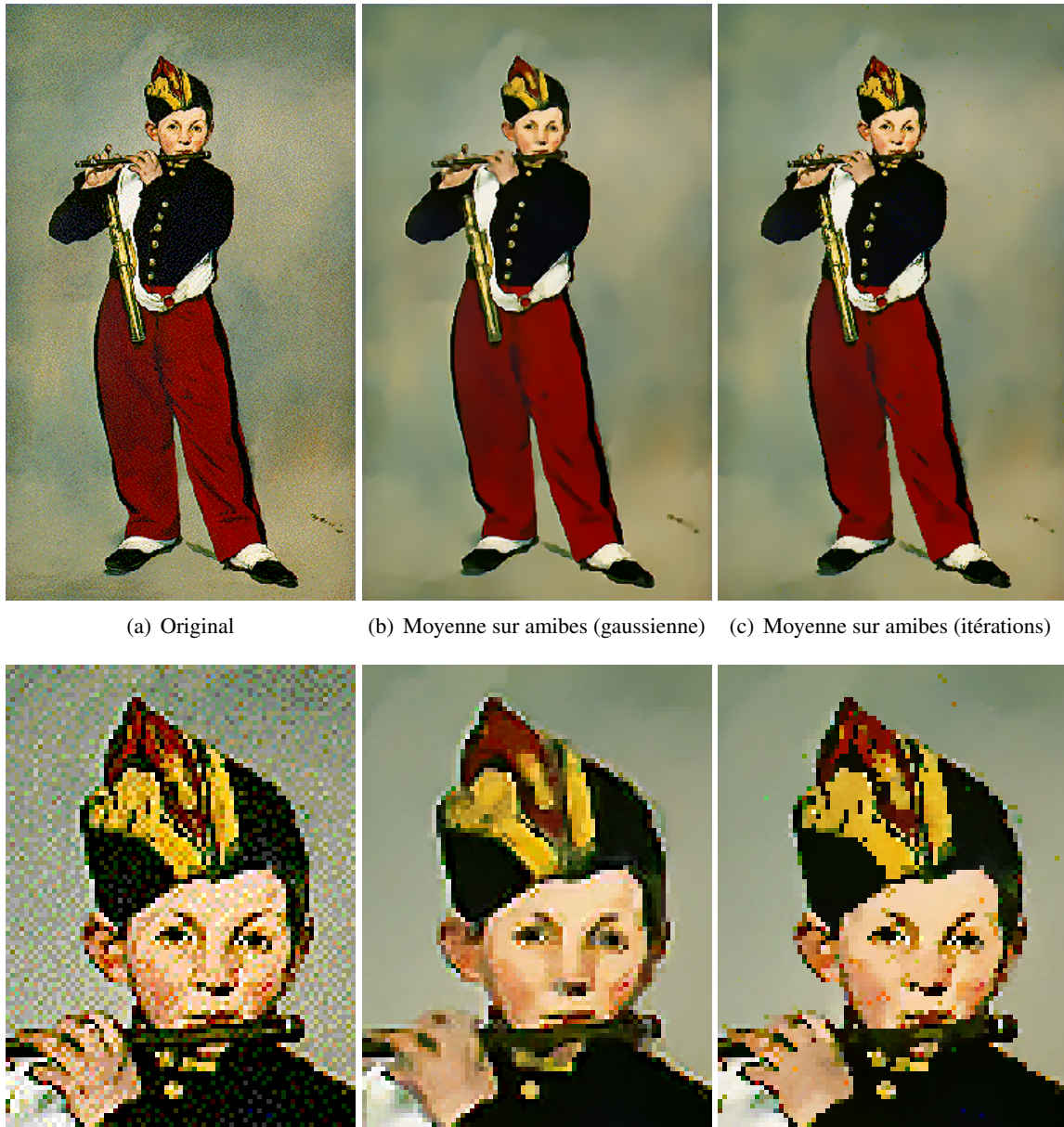
FIG. 4.19: Comparaison entre la moyenne sur amibes pilotées par la gaussienne, et la moyenne sur amibes pilotées par l'itération précédente de la moyenne sur amibes. La main est très peu attaquée dans la dernière image, et les sourcils ne commencent pas à fusionner avec les yeux.
