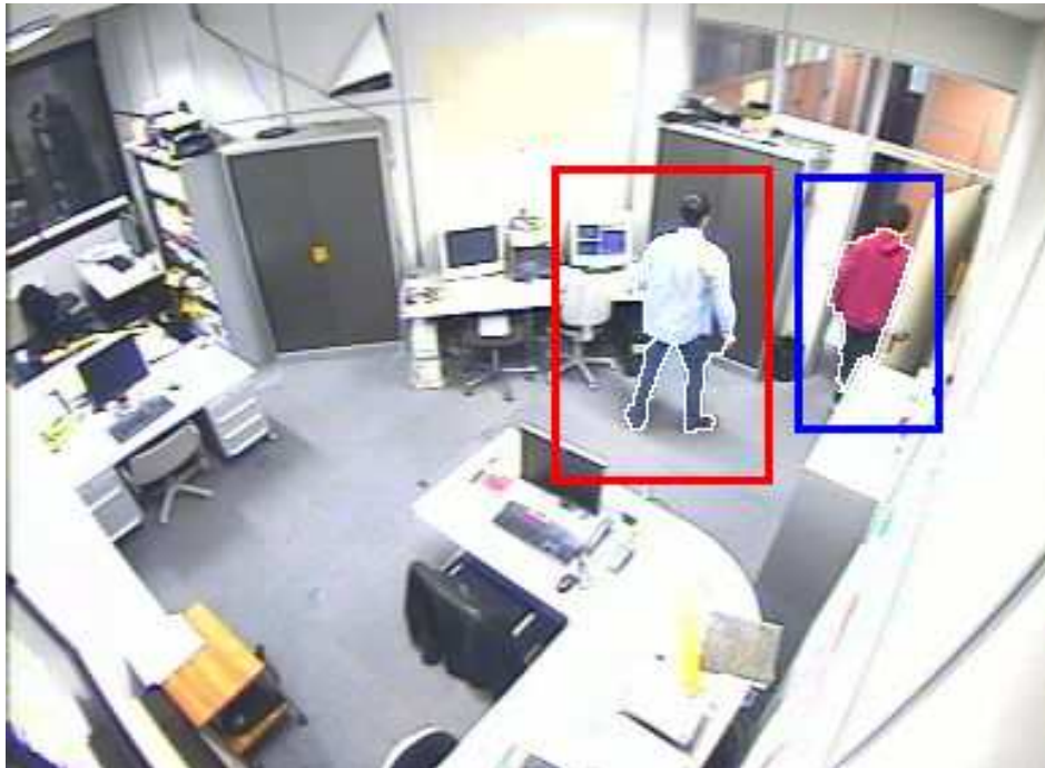
FIG. 9.11: La détection rapide des zones d'intérêt permet d'accélérer le traitement par un facteur 100 sur certains jeux de données.
