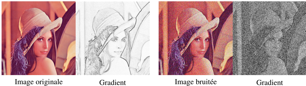
FIG. 5.1: Impact du bruit sur le gradient (le gradient utilisé est le gradient morphologique, mais le résultat est valable pour la plupart des opérateurs de ce type).
