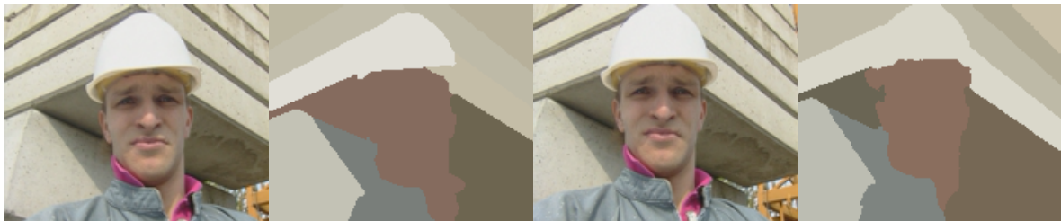
FIG. 2.5: Segmentation hiérarchique en 10 régions de deux images d'une même séquence. Dans un cas (gauche) le visage a fusionné avec le fond, dans l'autre cas (droite), c'est le casque qui a fusionné avec le fond.
