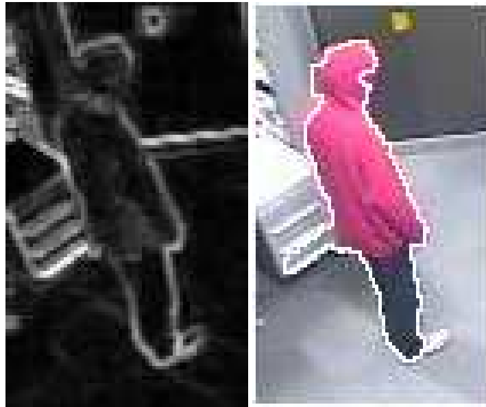
FIG. 9.8: L'utilisation directe du gradient couleur peut causer des "fuites" lors de l'inondation. Ainsi le gradient très fort le long des tiroirs du bureau va fixer l'inondation et causer une erreur de segmentation sur la gauche de la silhouette.
