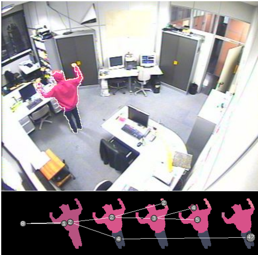
FIG. 9.16: Modélisation de la silhouette par un arbre de resegmentations «top-down».
