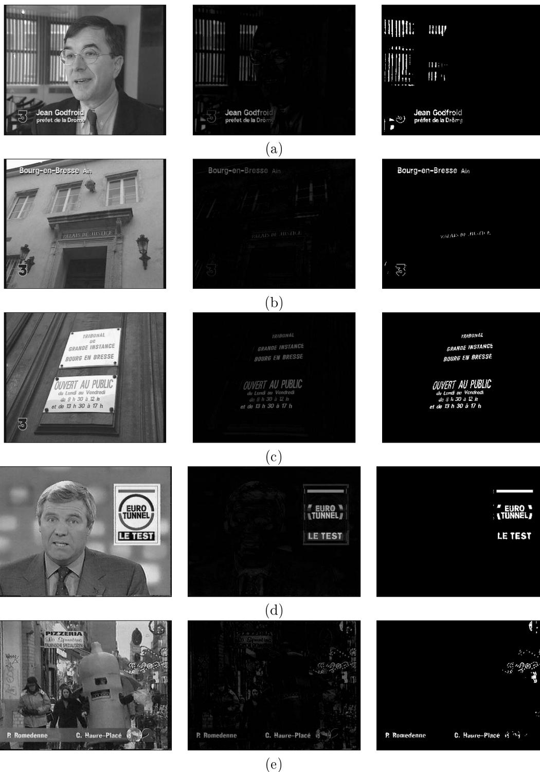
FIG. 6.5: Exemples de détection de texte, sur diverses images clés. On présente successivement l'image originale, le résultat de l'algorithme et un seuillage de ce résultat, utilisé comme entrée d'un ROC.
