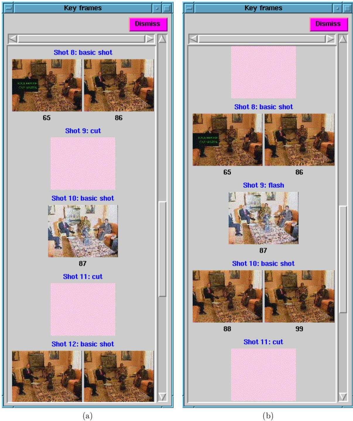
FIG. 4.7: Modification de la structure de document vidéo dans le cas d'un flash : (a) Avant correction, deux fausses alarmes sont présentes dues à la présence d'un flash détecté comme prise de vue à part entière. (b) Après correction, le flash est intégré dans la prise de vue qui se poursuit de part et d'autre.
