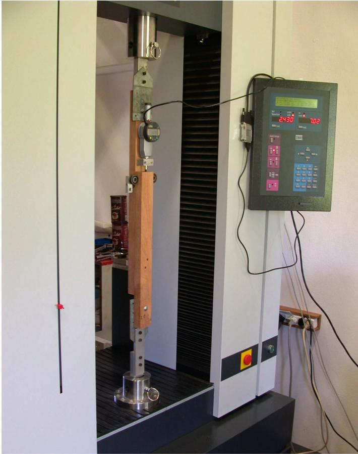
Figure 34 Essai de cisaillement de clou sur la MTS
