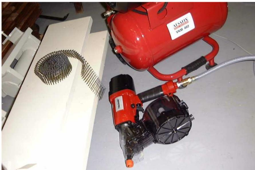
**Figure 33** Pistolet cloueur, compresseur et bobine de clous
