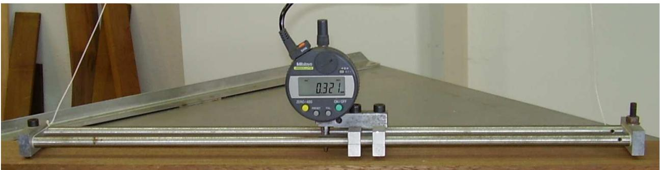
Figure 63 Fléchomètre
