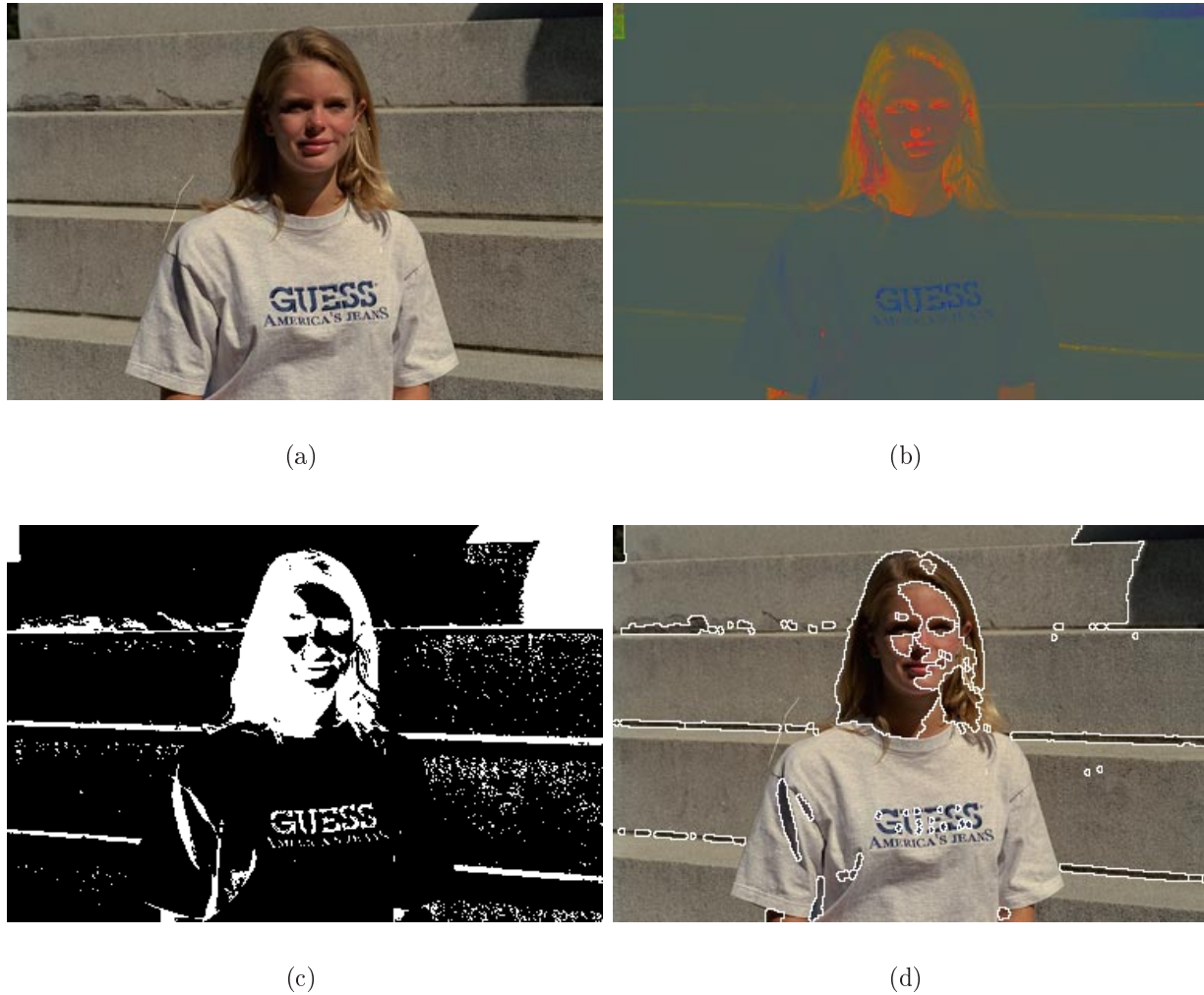
FIG. 5.23 – Exemple de détection : (a) Image originale (b) Image normalisée (c) Masque des ombres (d) Régions identifiées comme des ombres dans l'image originale Les pixels d'ombre isolés sont éliminés par l'ouverture morphologique finale. Grâce à cette étape, nous ne prenons pas en considération les ombres générées par les textures.
