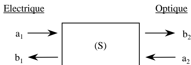
Figure 5-3 : définition de la matrice de diffusion. L'indice 1 se rapporte au champ électrique et l'indice 2 à l'impulsion optique. La lettre a se rapporte aux champs incidents et la lettre b aux champs émergents.
