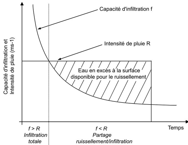
FIG. 1.3 – Représentation schématique du ruissellement hortonien
