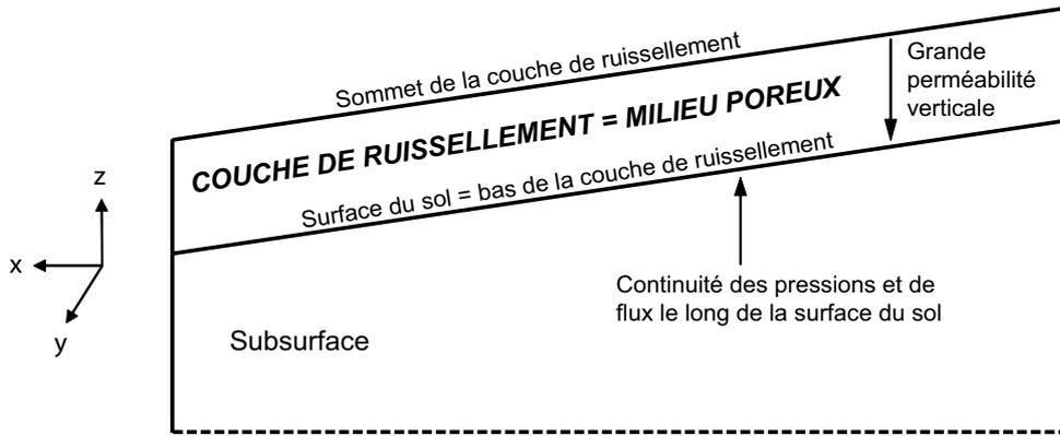
FIG. 1.2 – Illustration du concept de couche de ruissellement
