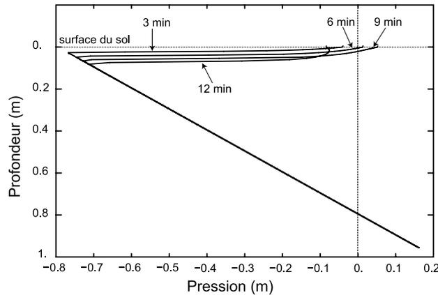
FIG. 3.1 – Profils de pression à 3, 6, 9 et 12 minutes
