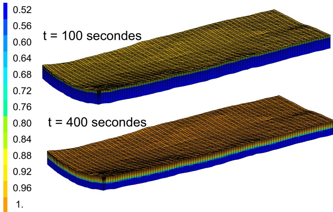
FIG. 3.10 – Champ de saturation dans la parcelle à  $t = 100$  secondes et  $t = 350$  secondes ; le domaine de calcul est transformé pour voir le domaine de subsurface (épaisseur réelle 5 fois plus petite)
