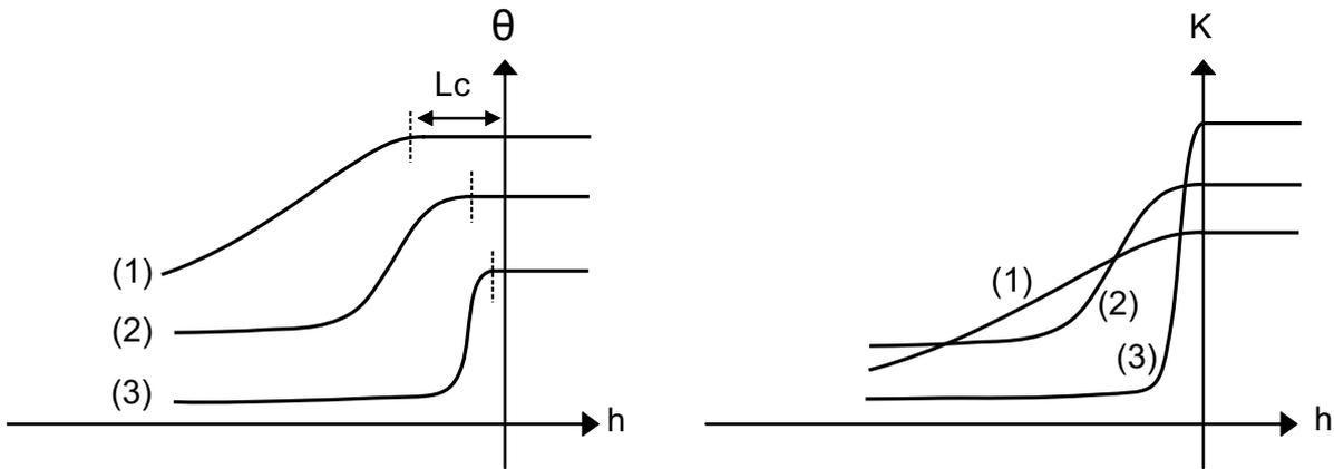
FIG. 1.1 – Lois de teneur en eau  $\theta$  et de conductivité hydraulique  $K$  en fonction de la pression capillaire  $h$  pour trois sols hypothétiques sans hystérésis (1) Argile (2) Sable marneux (3) Sable .
