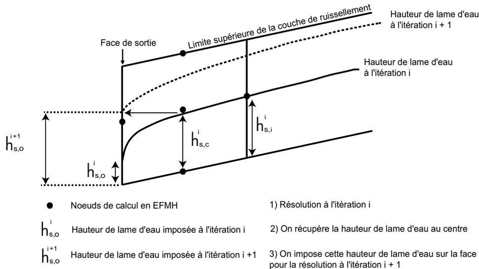
FIG. 3.1 – Condition à la limite de charge itérative en sortie de couche de ruissellement
