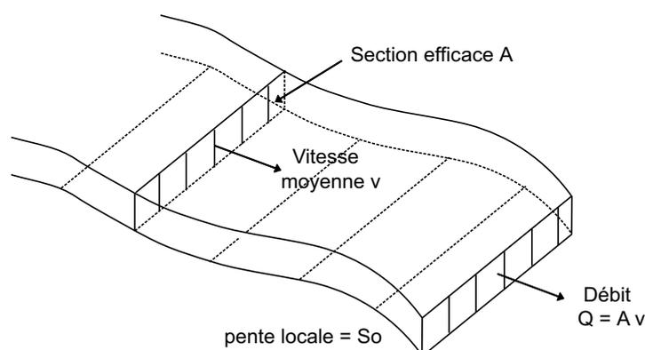
FIG. 1.3 – Schéma d'une lame d'eau idéalisée
