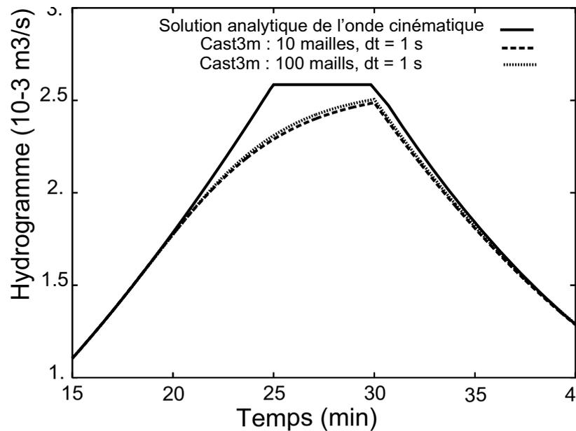
FIG. 2.2 – Comparaison entre le modèle de ruissellement Cast3m et la solution analytique de l'approximation de l'onde cinématique : effet de la discrétisation spatiale
