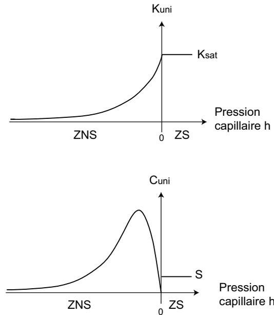
FIG. 1.1 – Représentation schématique des lois de conductivité hydraulique et de capacité capillaire utilisées dans l'équation unique décrivant les écoulements dans la zone saturée et la zone non saturée (ZNS = Zone non saturée = pression capillaire négative par convention ; ZS = Zone saturée = pression positive par convention).
