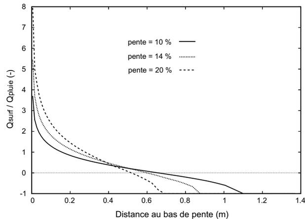
FIG. 1.11 – Projection du flux normalisé le long de la surface du sol pour les trois pentes considérées au régime permanent
