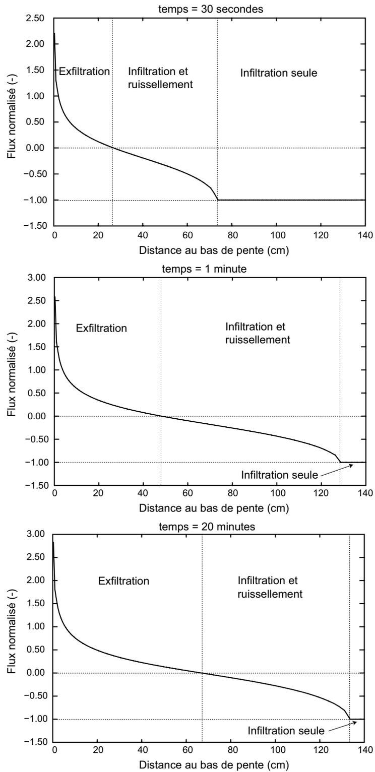
FIG. 4.4 – Projection du flux à la surface du sol à trois instants différents :  $t = 30$  secondes,  $t = 1$  minute et  $t = 20$  minutes
