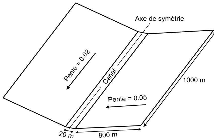
FIG. 2.3 – Représentation schématique de la géométrie de type "livre ouvert" de [Di Giammarco et al, 1996]
