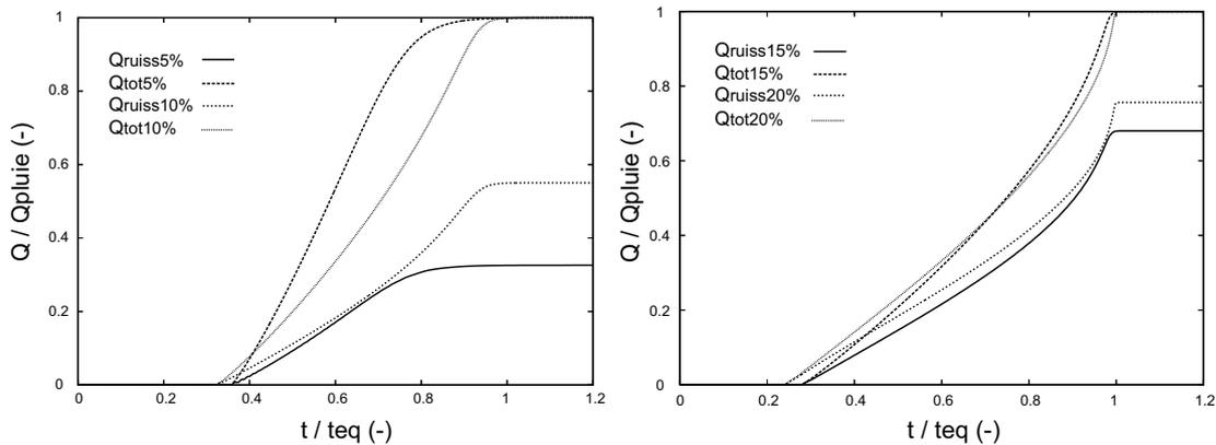
FIG. 1.8 – Évolution du flux total et du flux ruisselé normalisés en fonction du temps normalisés pour les quatre intensités de pluie considérées ( $Q_{ruissX\%}$  représente le flux ruisselé pour un rapport  $i / K_{sat}$  de  $X\%$ )
