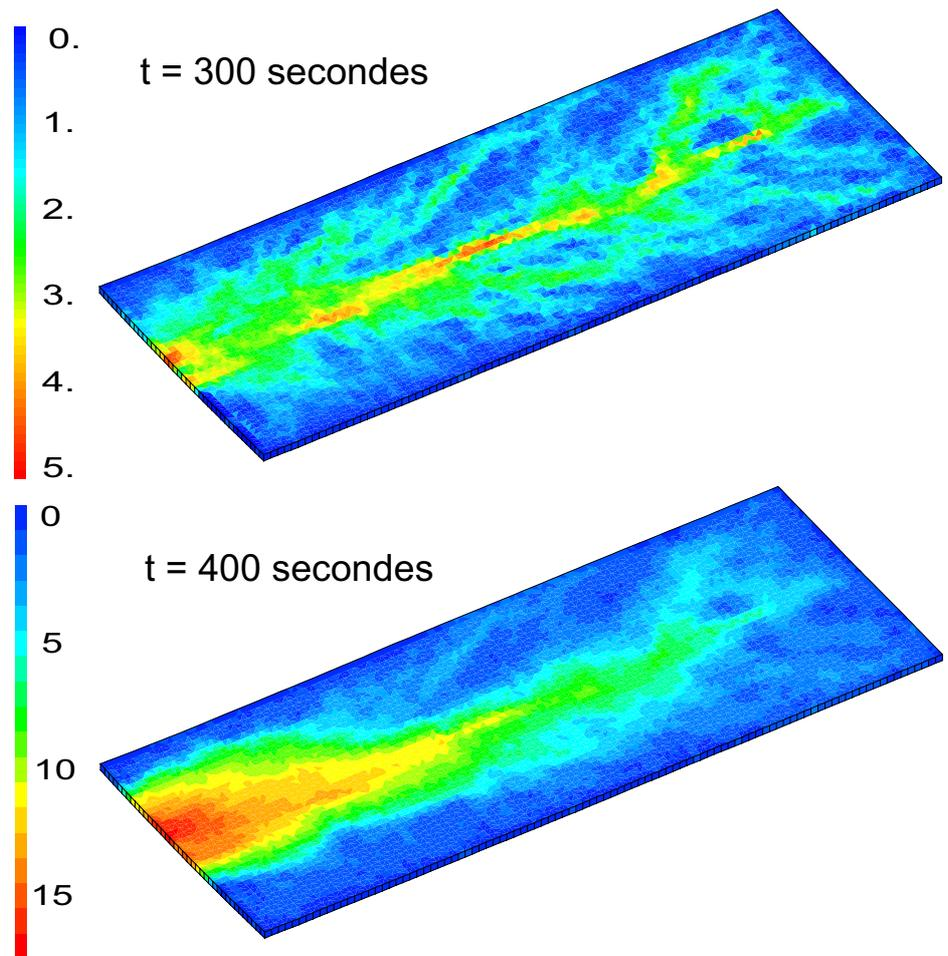
FIG. 3.11 – Hauteurs de lame d'eau à  $t = 300$  secondes et  $t = 400$  secondes
