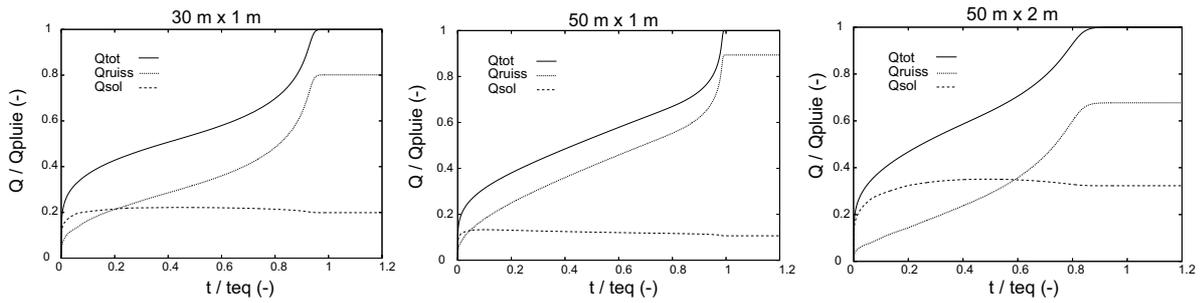
FIG. 4.14 – Évolutions des flux totaux, sortant par le sol et par la couche en fonction du temps pour les trois géométries considérées
