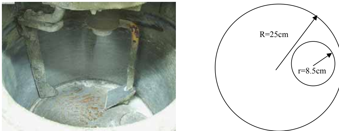
Figure II.62-Pales du malaxeur et volume du malaxage
