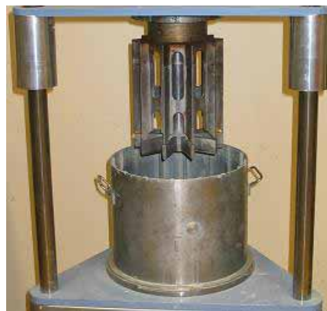
Rhéomètre BML à cylindres coaxiaux
