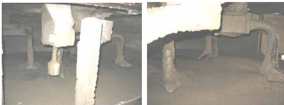
Figure II.116 - Vue intérieure du malaxeur.
