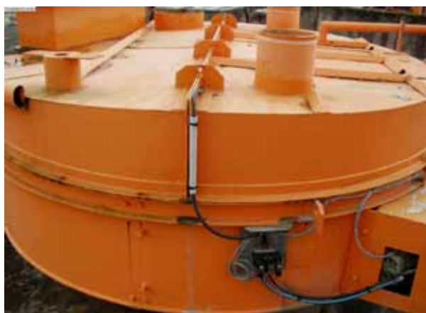
Figure II.96- Vue extérieure du malaxeur Pataud de 1 \text{ m}^3
