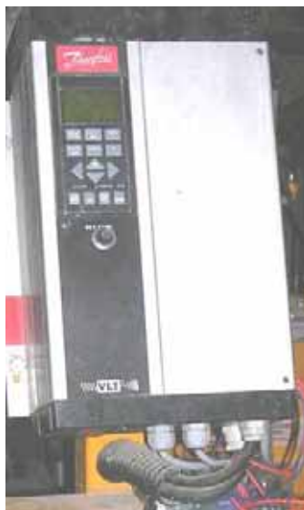
Figure II.64-Variateur Dansfoss VTL (Série 5000)
