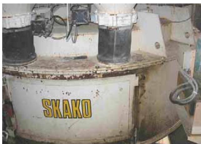
Figure II.115 - Vue extérieure du malaxeur.
