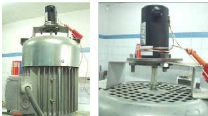
Figure II.75-Installation de la dynamo à vitesse
