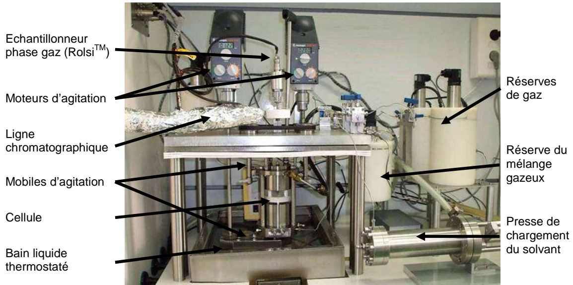
Figure 30. Appareillage expérimental pour les mesures sur les solutions aqueuses de MDEA-TETA
