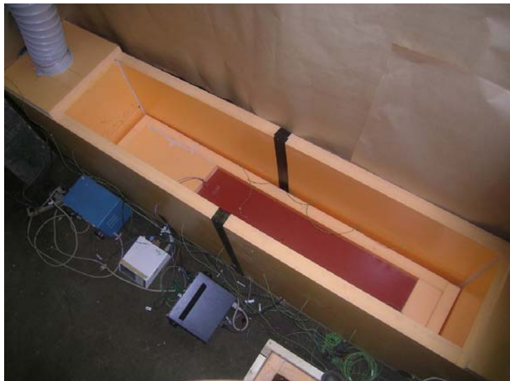
Figure 3.1 Cellule de caractérisation des échanges convectifs
