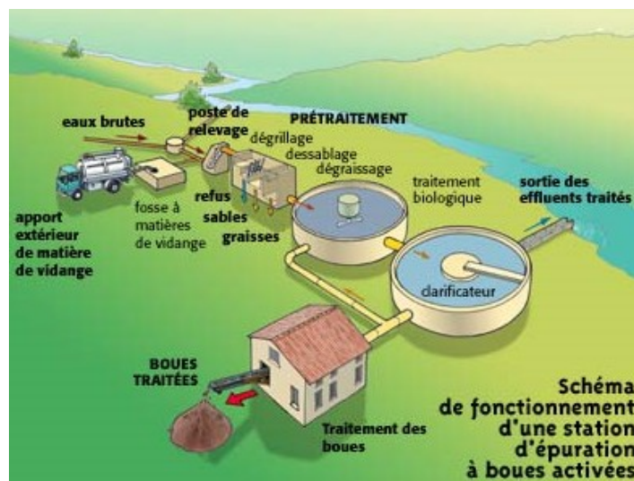
Figure 1.1 Schéma de fonctionnement d'une station d'épuration
