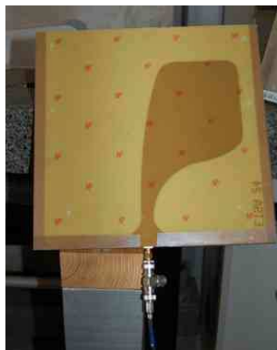
Figure 9.2. Antenne planaire imprimée, bande de détection 10-1200MHz. L'antenne a été réalisée au Laboratoire d'Electronique Antennes et Télécommunications (LEAT) de l'Université de Nice-Sophia Antipolis.
