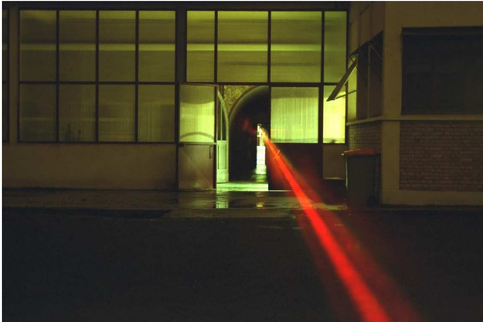
Figure 1.1. Photo qui montre l'expérience de propagation autoguidée au Laboratoire d'Optique Appliquée en 1996, où pour la première fois de la filamentation sur 50m a été démontrée.
