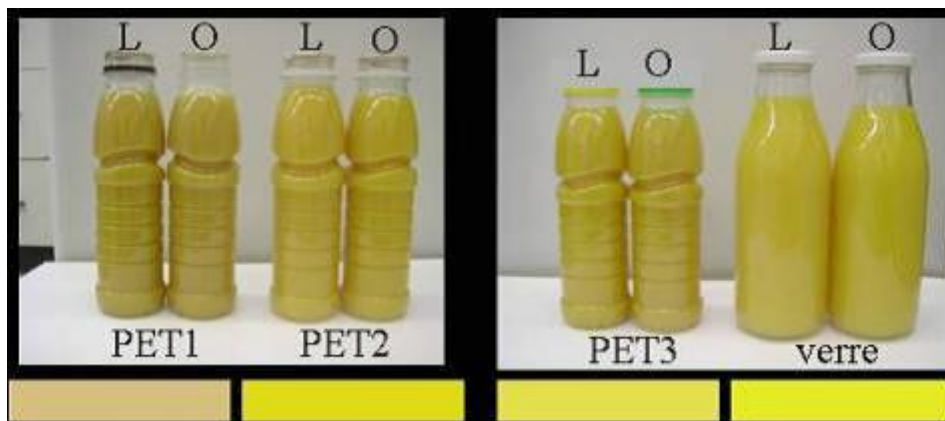
Figure 31. Bouteilles de jus d'orange emballées avec le PET1 (monocouche), PET2 (Bindox®) et PET3 (Actis Lite™) et le verre après 9 mois de stockage ambiant (L : éclairage artificiel, O : obscurité)
