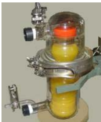
Figure 20. Cellule de perméation pour la mesure quantitative de la perméation
