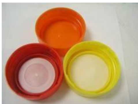
Figure 16. Bouchon A (orange) en PEHD, B (rouge) PEHD et joint en PEBD blanc avec absorbeur d'oxygène et C (jaune) avec joint multicouche blanc PEBD/EvOH/PEBD
