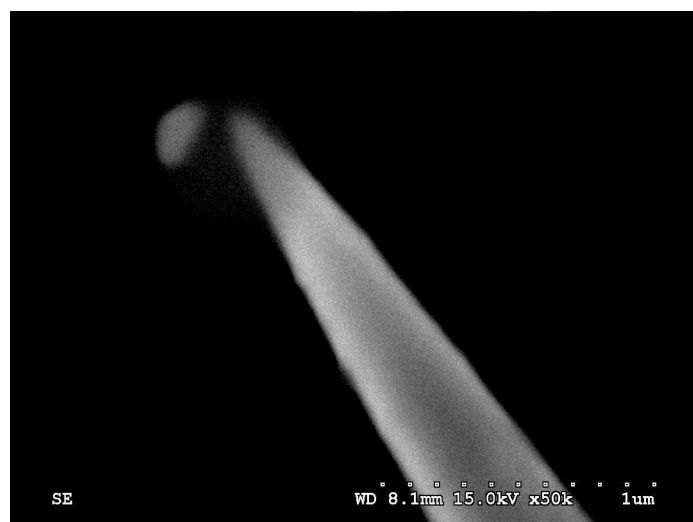
Figure IV-10 : nanoparticule de \text{PbF}_2:\text{Yb-Er} (20-10 %) collée au bout d'une pointe AFM.
