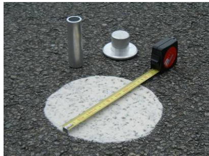
Figure II.12 : Mesure de la macrotexture PMT
