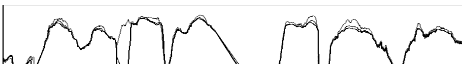
Figure V.7 : Évolution de la texture, cas du granulat D (PSV = 51)
