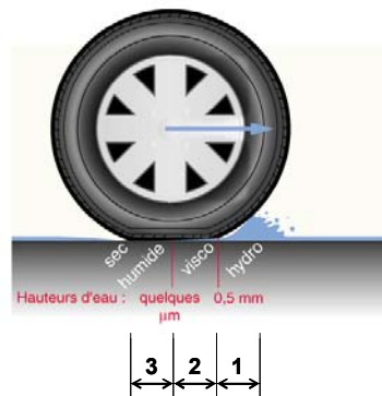
Figure II.2 : Description de l'aire de contact pneumatique/chaussée
