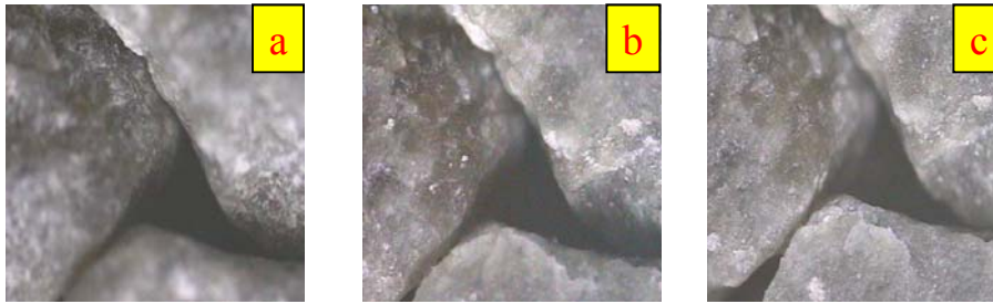
Figure VIII.2 : Les états naturels et polis d'un granulat
