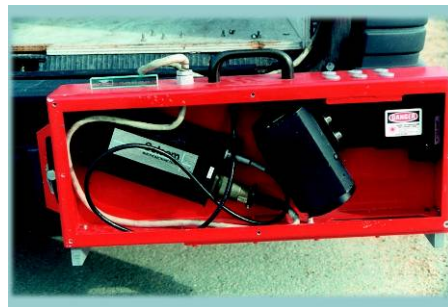
Figure II.13 : Méthode profilométrique : le RUGOLASER
