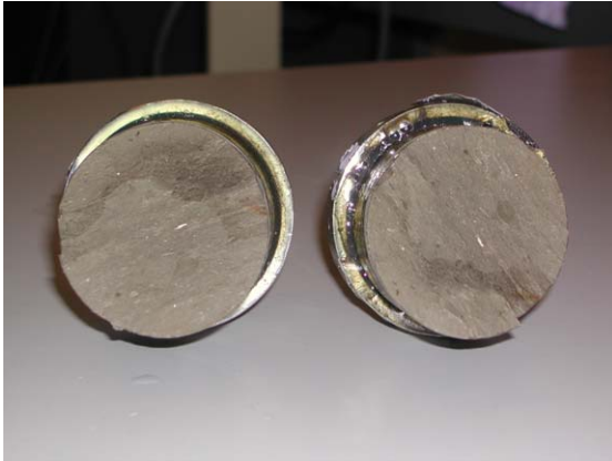
Figure III.47 - Photo d'échantillon soumis à la traction avant humectation.
