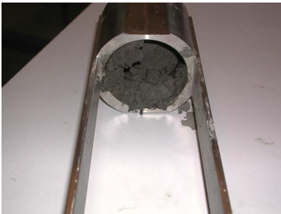
Figure III.48 - Photo d'échantillon d'argile de Mol après humectation.
