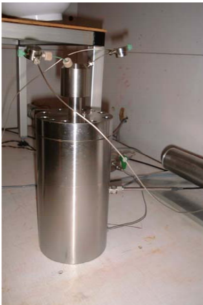
Figure III.13 - Quelques photos de l'appareillage de l'essai de confinement et de l'échantillon fissuré après démontage.
