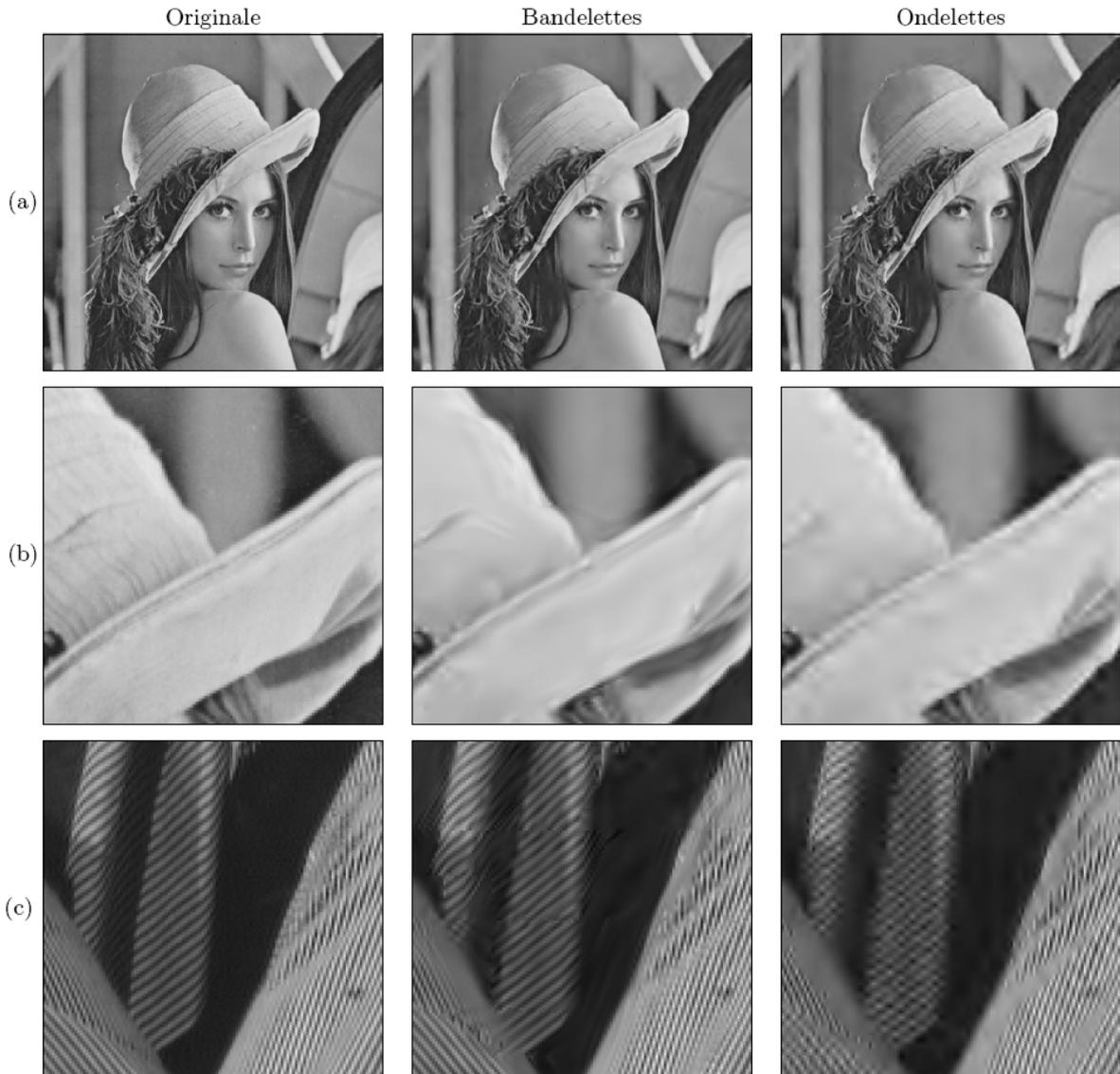
FIG. 3.13 – Résultats de bandelettes : (a) Lena, (b) détail de Lena, (c) détail de Barbara. Lena est à un PSNR de 33.04 dB en bandelettes contre 32,55 dB en ondelettes. Barbara a un PSNR de 31,22 dB en bandelettes contre 28.50 dB en ondelettes [LPM03]
