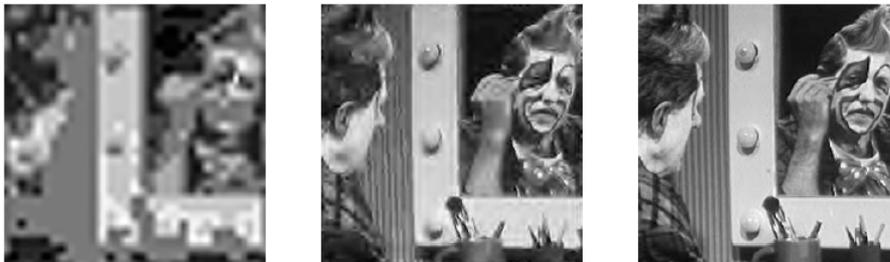
FIG. A.3 – Exemple de scalabilité SNR sur 3 niveaux
