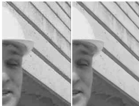
FIG. 3.33 – Résultat visuel pour une partie de l'image Foreman codée avec la BinDCT orientée (à droite) comparée à la DCT flottante de JPEG (à gauche) [XXW07]
