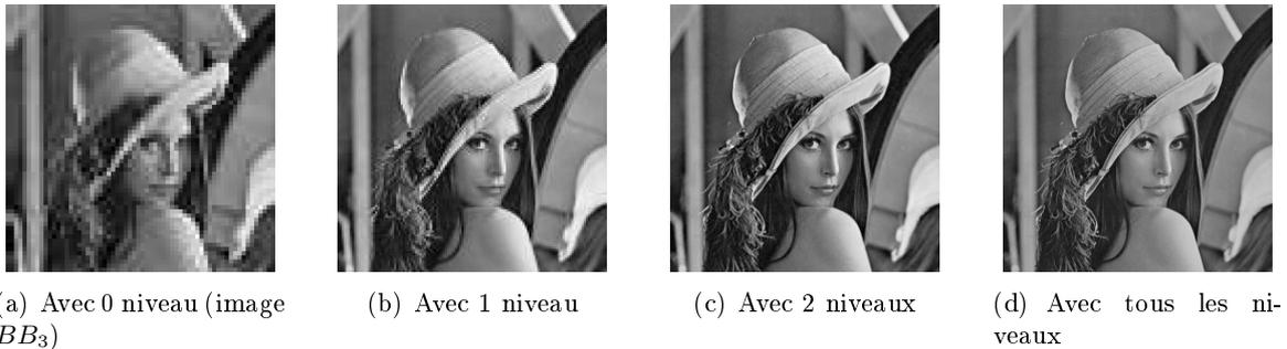
FIG. 2.10 – Reconstruction de l’image Lena décomposée sur 3 niveaux [RSC01]
