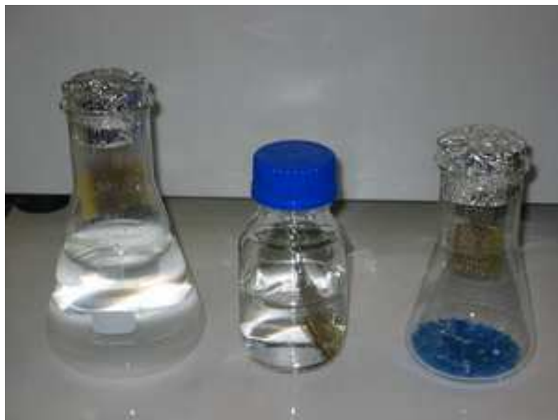
FIG. 4.1 – Flacons de sorption en atmosphère humide, en immersion dans un solvant et de désorption.
