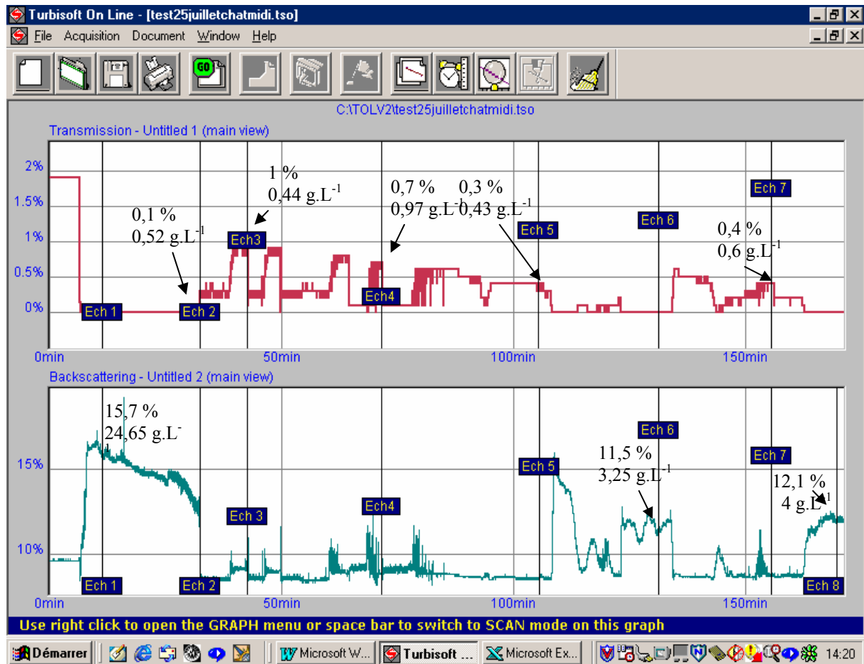
Figure 44 : Enregistrement de la transmission et de la rétrodiffusion lors des tests préliminaire sur le site de Châteauroux
