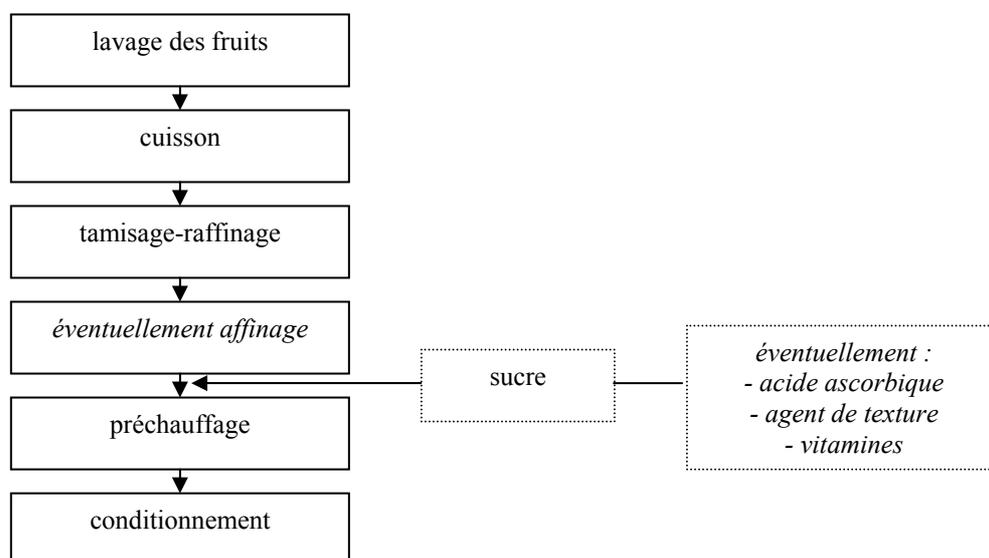
Figure 7 : Diagramme de fabrication des purées de fruits (Albagnac, *et al.*, 2002)
