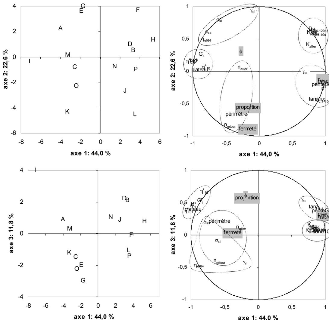
Figure 81 : Trois premières dimensions de l'ACP sur les données instrumentales (structurales et rhéologiques) de l'espace produits 16 suspensions modèles (issues du plan d'expériences complet)
