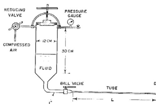
Figure 12 : Rhéomètre capillaire sous pression (Saravacos, 1968)
