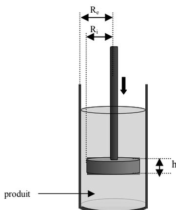
Figure 44 : Schéma du corps de mesure de rétro-extrusion
