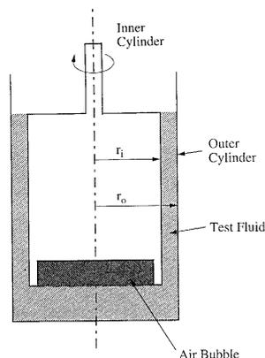
Figure 13 : Rhéomètre à cylindres coaxiaux (Rao, 1999)
