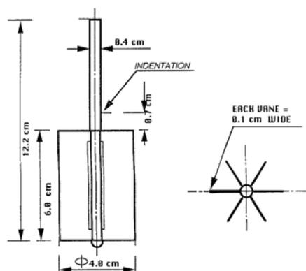
Figure 14 : Rhéomètre à ailette (Qiu and Rao, 1988)
