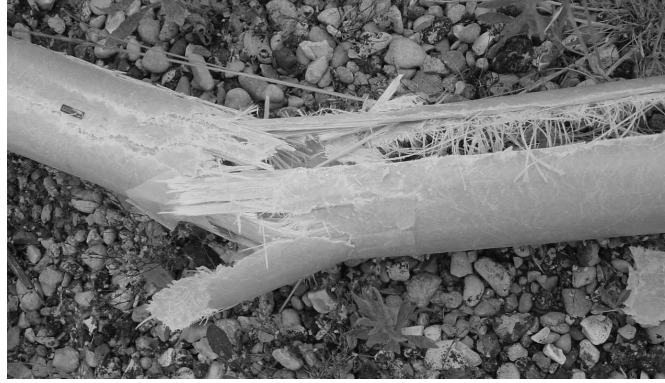
FIG. 2.16 – Rupture caractéristique d'un tube fléchi.
