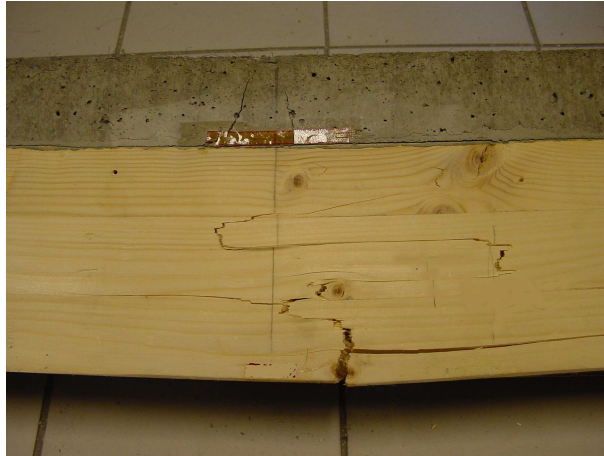
FIG. 3.7 – Rupture en traction du bois et du béton
