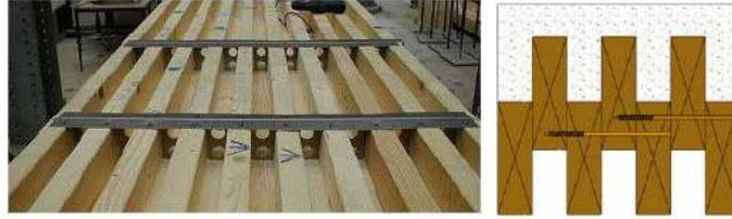
FIG. 1.10 – Dalle mixte bois béton nommée D-Dalle
