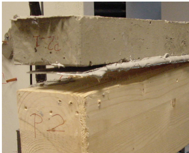
FIG. 3.10 – Rupture par arrachement du bois
