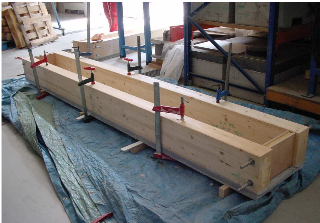
FIG. 4.6 – Corps d'épreuve avec les serre-joints
