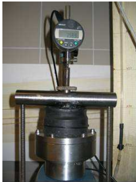
Figure 2-18. Cellule oedométrique avec mesure de succion
