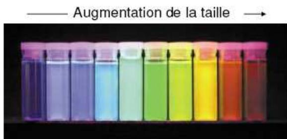
FIG. 1.2 – 10 solutions de nanoparticules de CdSe/ZnS de couleur d'émission distinctes, excitées sous une lampe éclairant dans le proche U.V. De gauche à droite, les maxima d'émission sont situés à 443, 473, 481, 500, 518, 543, 565, 587, 610, et 655 nm.<sup>[9]</sup>
