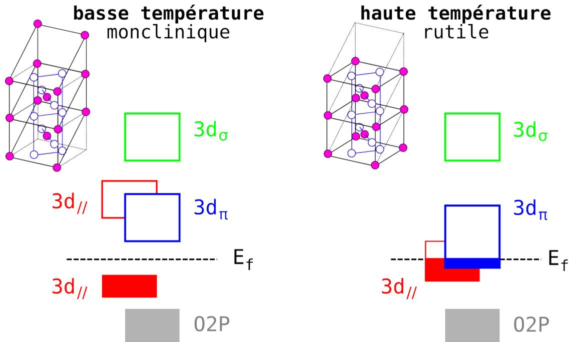
**Figure 1.4** – Représentation schématique des niveaux des bandes de valence et de conduction dans du  $\text{VO}_2$ , ainsi que l'organisation de la structure cristalline pour les deux phases, basse température et haute température.
