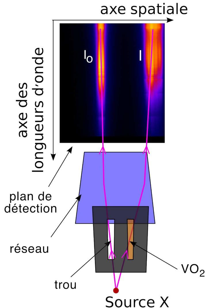
**Figure 5.8** – Schéma représentant la source X, l'échantillon, le réseau, et le plan de détection. Le spectromètre ayant une résolution spatiale, permet de mesurer le spectre de référence ( $I_0$ ) et le spectre absorbé par le  $\text{VO}_2$  ( $I$ ).
