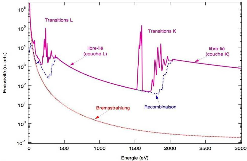
**Figure 2.1** – Spectre type d'émission de rayonnement X d'un plasma d'aluminium ( $300 \text{ eV} - 0,1 \text{ g/cm}^3$ ), séparant les différentes contributions. Tous les mécanismes représentés ont leur équivalence en absorption.
