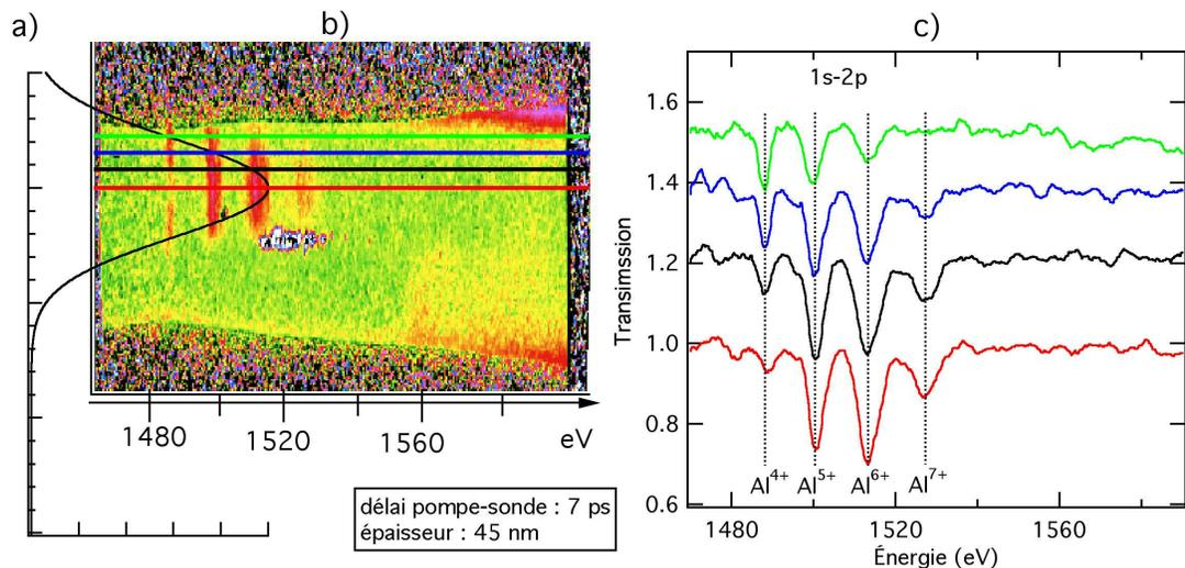
**Figure 4.14** – Transmission expérimentale d'un spectre d'absorption d'une feuille d'aluminium d'épaisseur 40 nm, 7 ps après l'impulsion laser de chauffage. (a) représente la coupe correspondant à la tache focale du faisceau de chauffage, (b) le spectre brut, et (c) les 4 coupes correspondant aux 4 positions, soit 4 intensités lasers différentes.
