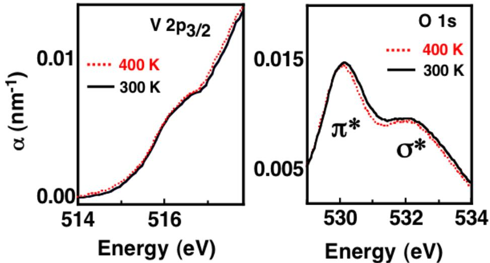
**Figure 5.2** – Absorption du VO<sub>2</sub> obtenue par Cavalleri et al. (2004) présentant les phases à basse (trait continu) et à haute températures (pointillés), pour deux gammes d'énergie. À gauche, autour du pic V2p<sub>3/2</sub>, et à droite autour des pics O1s.
