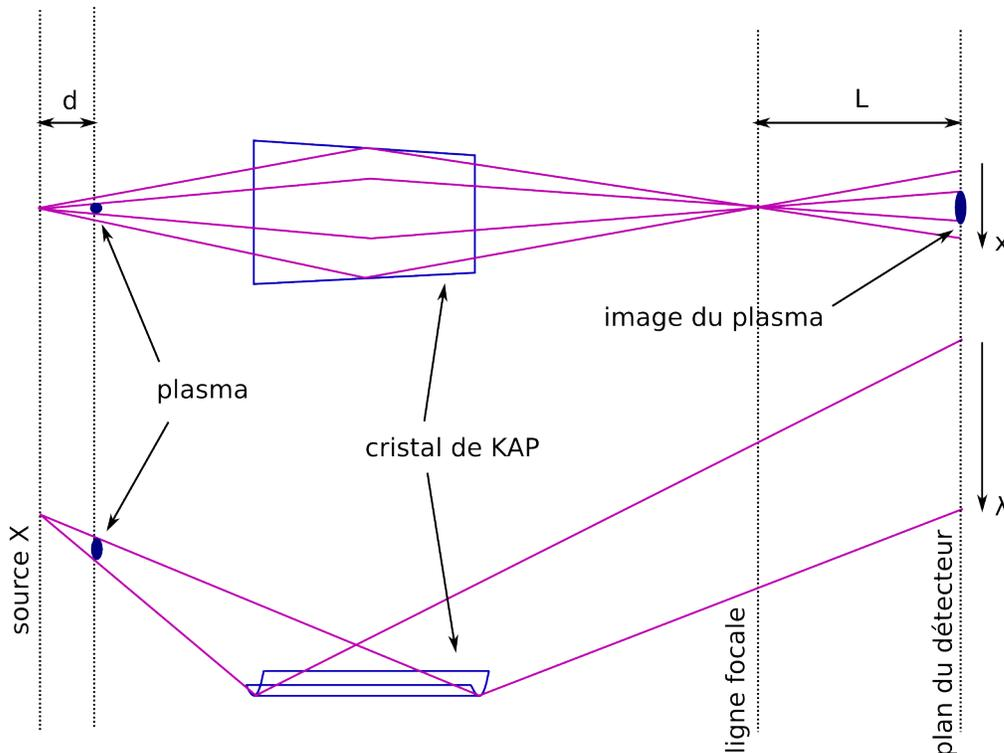
**Figure 3.7** – Schéma représentant deux vues des divers composants du spectromètre à cristal tronconique. On montre comment on obtient la résolution spatiale (en haut), et la résolution spectrale (en bas).
