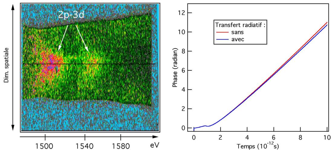
**Figure 4.23** – a) Spectre brut d'un plasma de brome (25 nm  $\text{Si}_3\text{N}_4$  + 50 nm KBr + 20 nm C). b) Phase mesurée par FDI (carrés) et calculée avec MULTI-FS par deux simulations hydrodynamiques différentes : avec (courbe rouge) et sans (courbe noire) le transfert radiatif.
