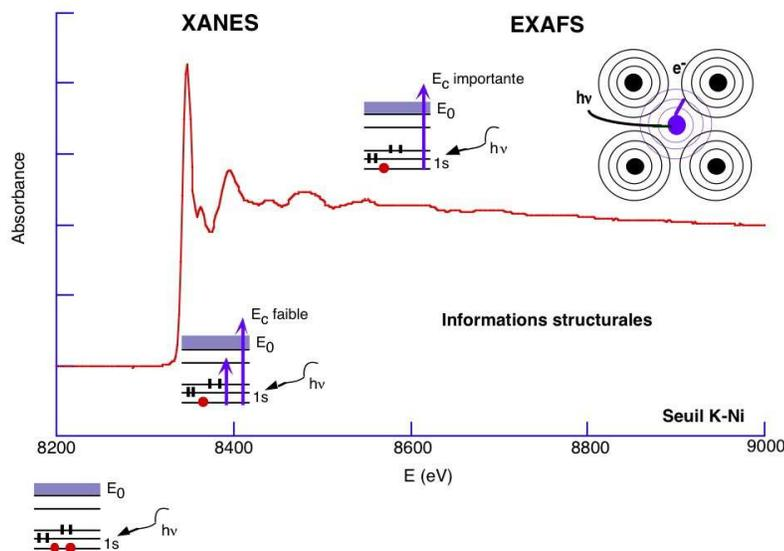
**Figure 2.3** – Schéma présentant les structures d'absorption du rayonnement X proche des seuils (XAS). On peut séparer cette structure en deux parties. La première, le XANES est comprise entre -10 et 50 eV après le seuil, la seconde, l'EXAFS se trouve au delà.
