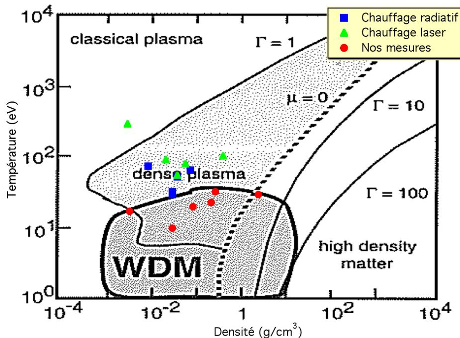
**Figure 4.22** – Diagramme densité-température présentant la région définie comme la *warm dense matter* pour l'aluminium (figure provenant de Lee et al. 2003). Les points présentent des points de mesure d'absorption pour un plasma d'aluminium par chauffage radiatif (carrés bleus), par chauffage laser (triangles verts), et ceux réalisés lors de notre expérience (ronds rouges).
