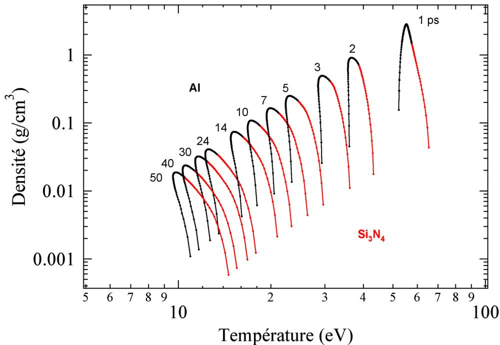
**Figure 3.18** – Différents couples de densités-températures le long des 100 cellules du plasma, pour différents délais après l'impulsion laser, entre 1 et 50 ps. Les cellules en rouges correspondent à l'épaisseur du  $Si_3N_4$ , en noires celles de l'aluminium.
