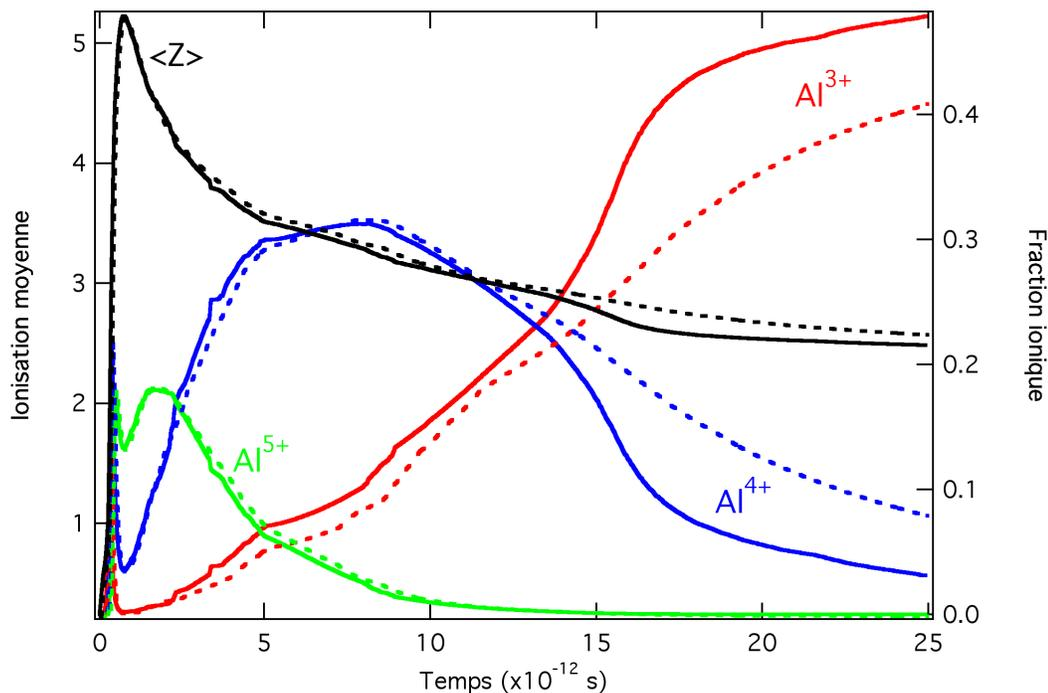
**Figure 4.12** – Évolution temporelle des pourcentages des fractions ioniques pour les ions Al<sup>3+</sup>, Al<sup>4+</sup> et Al<sup>5+</sup>, et évolution de l'ionisation moyenne  $\langle Z \rangle$  calculées avec TRANSPEC dans des conditions instationnaires (courbes en pointillés) et stationnaires (courbes pleines).
