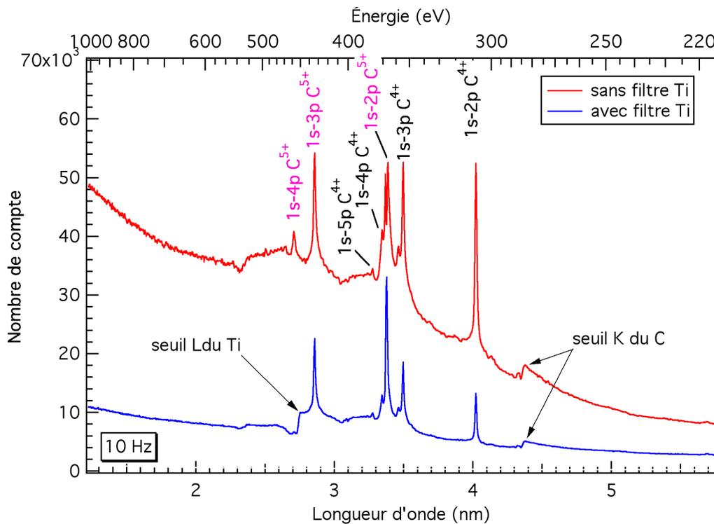
**Figure 5.11** – Coupes des spectres d'émission du carbone intégré sur 800 pixels, provenant de la figure 5.10. La courbe du haut (fig. 5.10a) est mesurée avec un filtre composé de 102,7 nm d'Al déposé sur 114 nm de polyimide, plus une protection d'un filtre de 117,3 nm de polyimide. La courbe du bas (fig. 5.10b) est mesurée en ajoutant un filtre supplémentaire composé de 160 nm de titane et 118,2 nm de polyimide.
