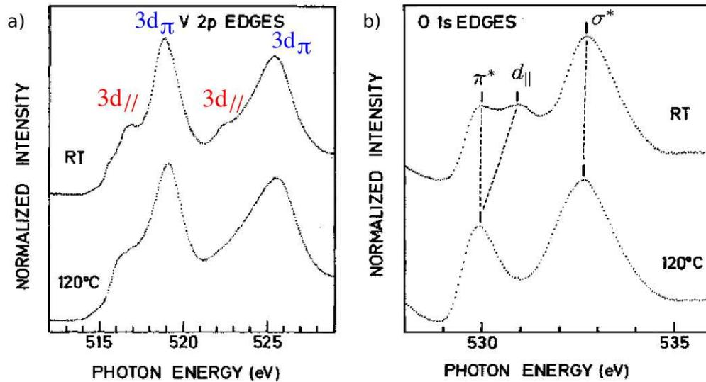
**Figure 5.5** – Résultats obtenus par Abbate et al. (1991) sur l'absorption de rayonnement X dans du  $\text{VO}_2$ , dans les phases basse et haute température. (a) présente les transitions à partir des niveaux  $2p_{3/2}$  et  $2p_{1/2}$  du vanadium, (b) présente celles obtenues à partir du niveau  $1s$  de l'oxygène.
