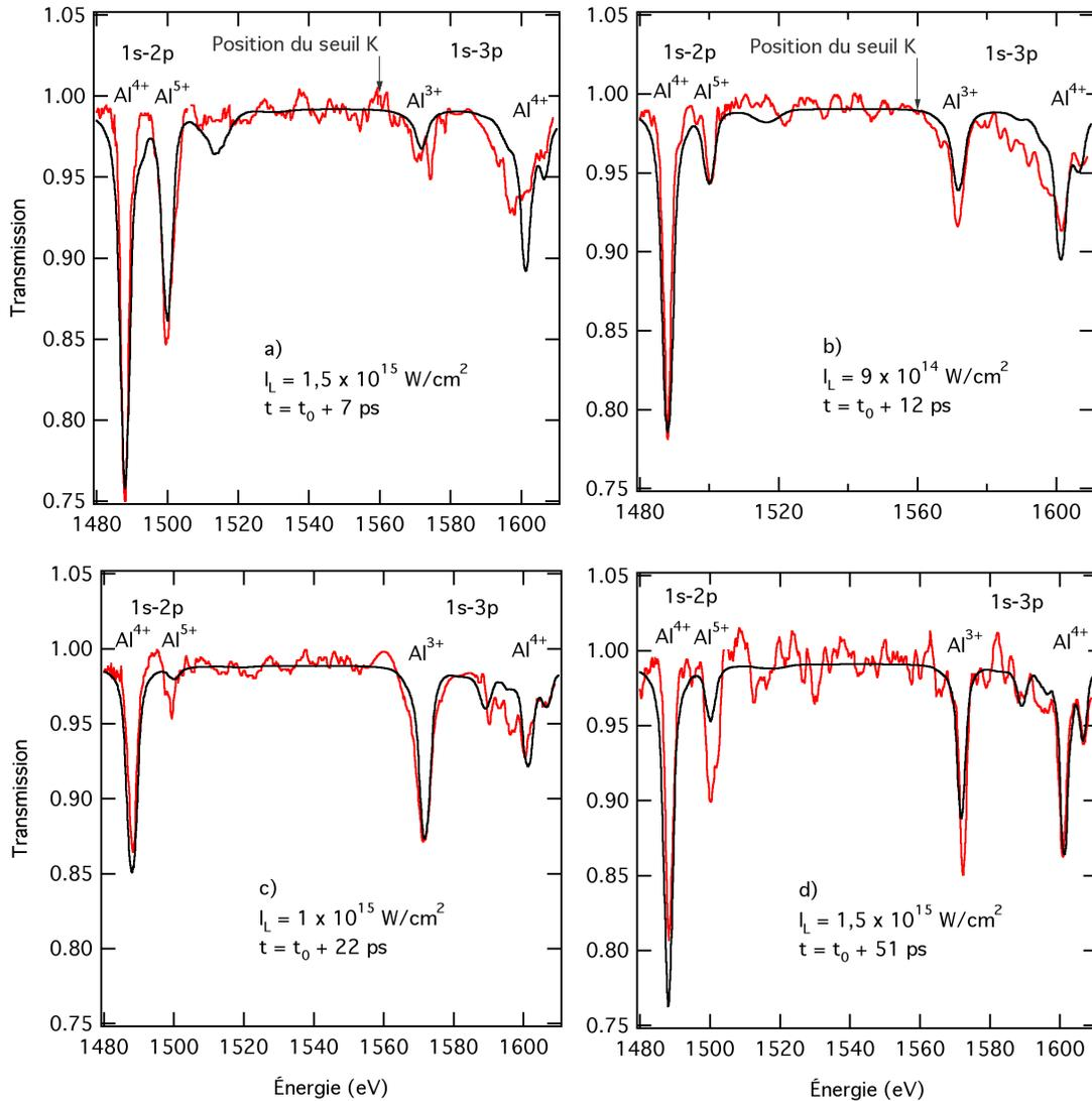
**Figure 4.19** – Spectres de transmission mesurés à différents temps après le faisceau de chauffage (courbes noires), comparées aux spectres calculés (courbes rouges) avec les paramètres du plasma issu du diagnostic FDI (voir figure 4.17).
