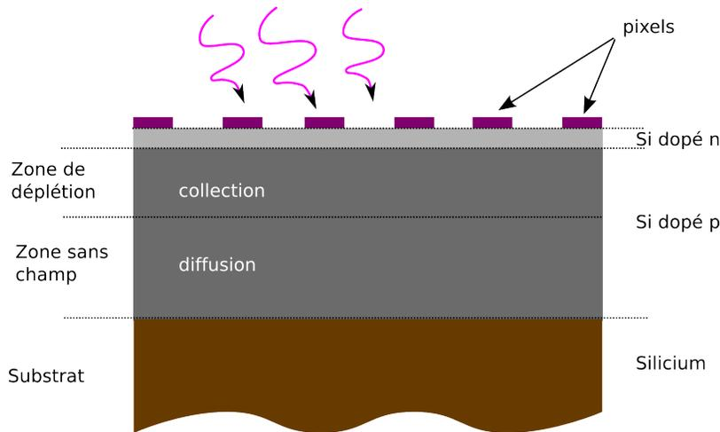
**Figure 3.10** – Représentation d’une coupe d’une caméra CCD, identifiant les différents constituants : pixels, Si dopé n, Si dopé p (séparer en deux zones, déplétion et sans champ), et le substrat de silicium.
