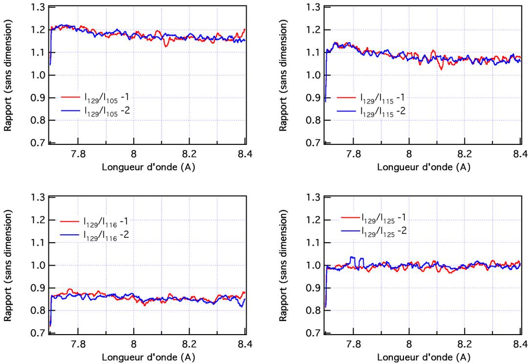
**Figure 4.6** – Courbes présentant le rapport entre différents spectres de la source de rayonnement X. Un tir (n° 129) est comparé à quatre autres (n°s 105, 115, 116, et 125), pour deux positions spatiales : au centre (courbes rouges) et sur un bord (courbes bleues).
