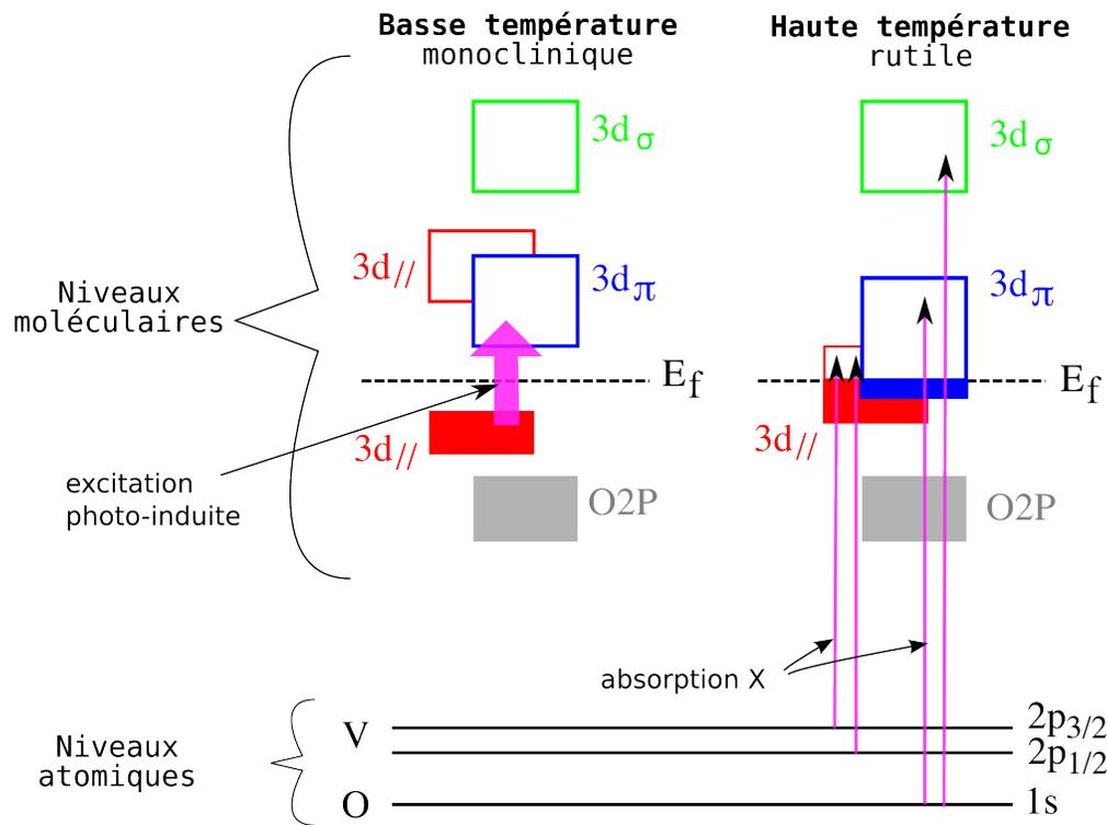
**Figure 5.4** – Représentation des niveaux moléculaires et atomiques dans le VO<sub>2</sub> pour les deux phases, basse et haute températures.
