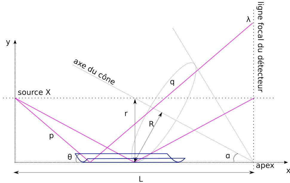
**Figure 3.6** – Schéma (plan  $x - y$ ) du mécanisme de focalisation du spectromètre conique. La source est située à l'origine des axes,  $L$  est la distance entre la source et le plan image,  $(x, y, z)$  est le point d'incidence,  $p$  et  $q$  sont les rayons incident et réfléchi,  $R$  et  $r$  sont les rayons de courbure locaux réel et approché. Deux rayons sont montrés; celui qui est incident au centre correspond (en  $x, y$ ) à la meilleure focalisation.
