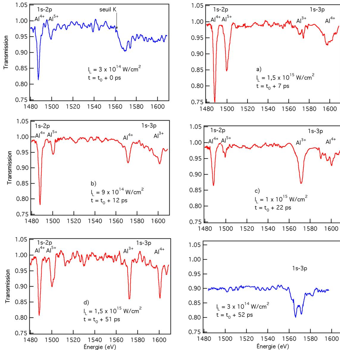
**Figure 4.16** – Coupes, au centre de la tache focale du faisceau de chauffage, des spectres de transmission présentés figure 4.15. Sont également indiqués le délai entre la pompe et la sonde, et l'intensité laser de la pompe.
