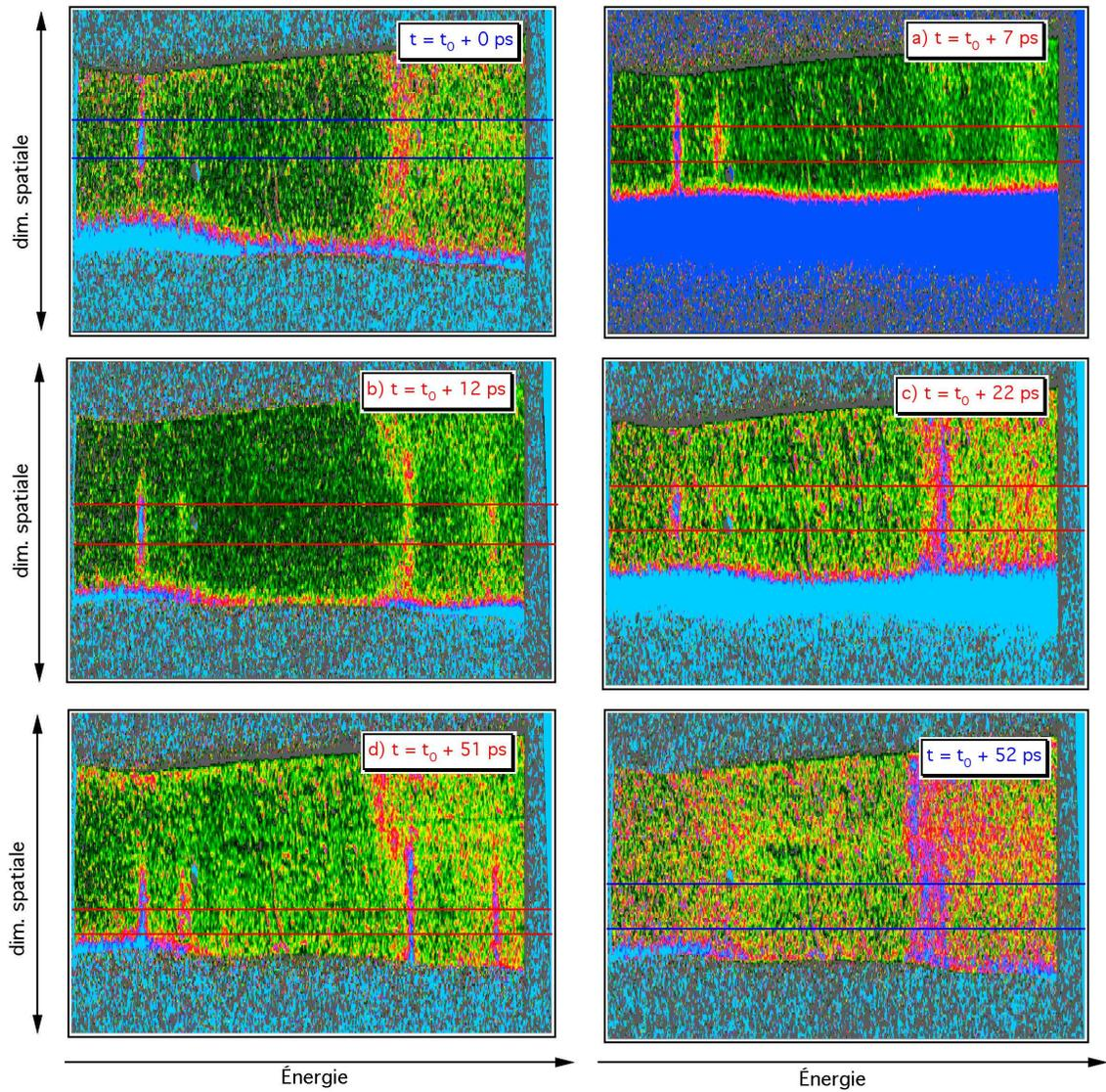
**Figure 4.15** – Six spectres expérimentaux, mesurés pour différents délais entre la pompe et la sonde. Les traits représentent les différentes zones permettant de tracer les coupes présentées sur la figures 4.16.
