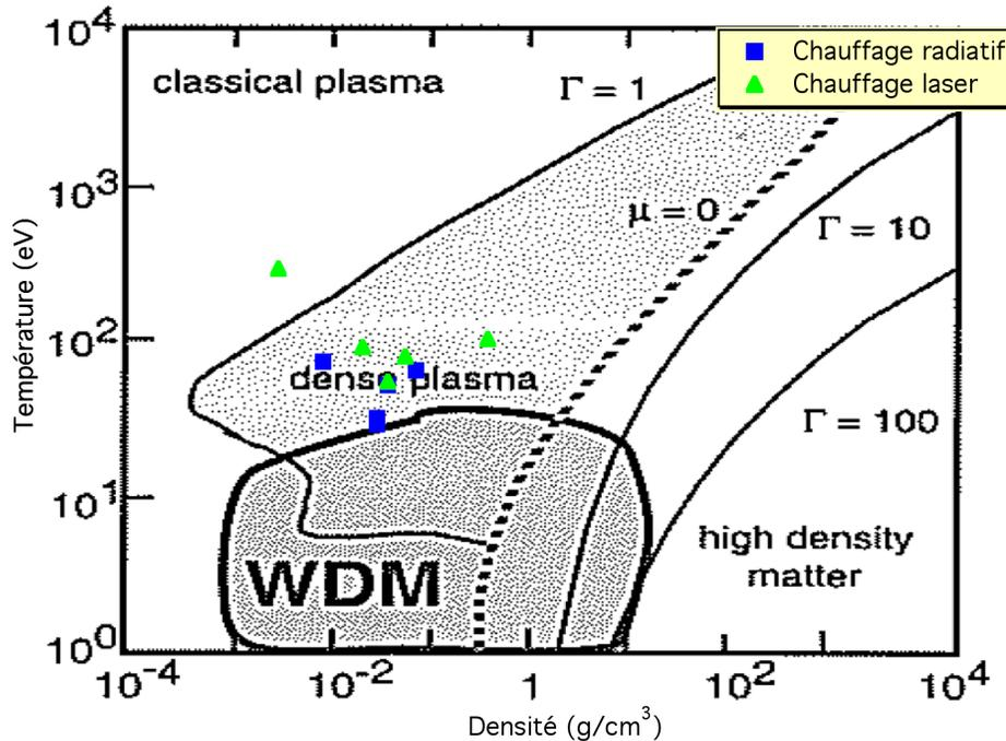
**Figure 4.1** – Diagramme densité-température présentant la région définie comme la *warm dense matter* pour l'aluminium (figure provenant de Lee et al. 2003). Les points présentent des mesures d'absorption pour un plasma d'aluminium par chauffage radiatif (carrés bleus), et par chauffage laser (triangles verts).
