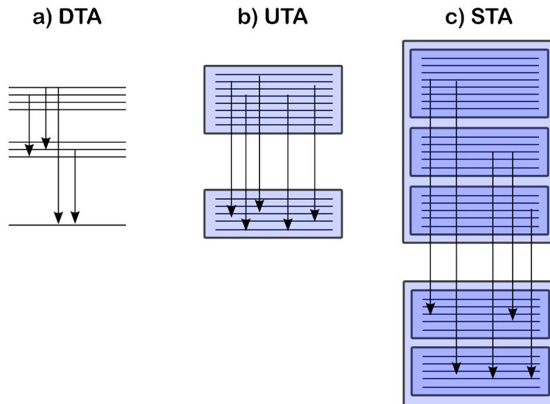
**Figure 2.2** – Niveaux d'énergie à calculer pour différents éléments. a) Pour les éléments légers, on calcule toutes les transitions connues. b) Pour les éléments mi-lourds on regroupe en configuration (UTA) les niveaux qui sont, entre eux, proches de l'ETL. c) Pour les éléments lourds, on regroupe les configurations (proche de l'ETL en elles) en super-configuration (STA).
