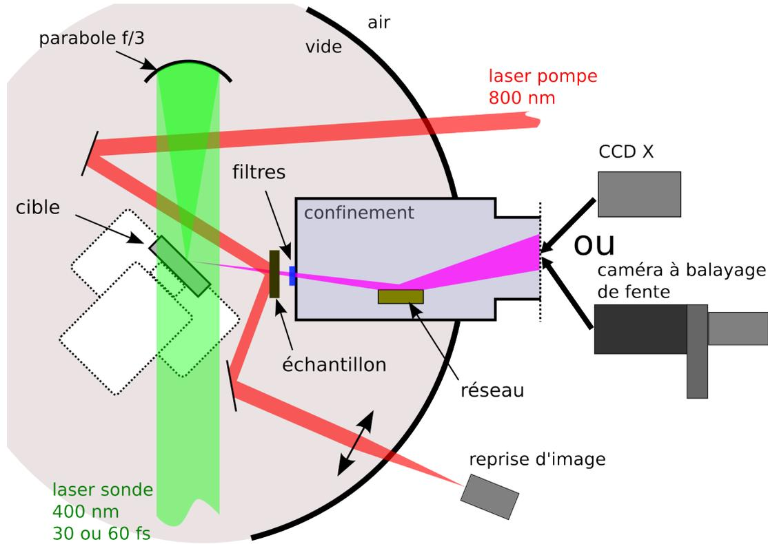
**Figure 5.6** – Schéma expérimental présentant les principaux éléments : lasers, cible, filtres, réseau, et détecteurs (caméra CCD ou caméra à balayage de fente). Le faisceau à 400 nm, indiqué en vert, passe au dessus du support de cible puis est focalisé au centre de la chambre par le miroir parabolique.
