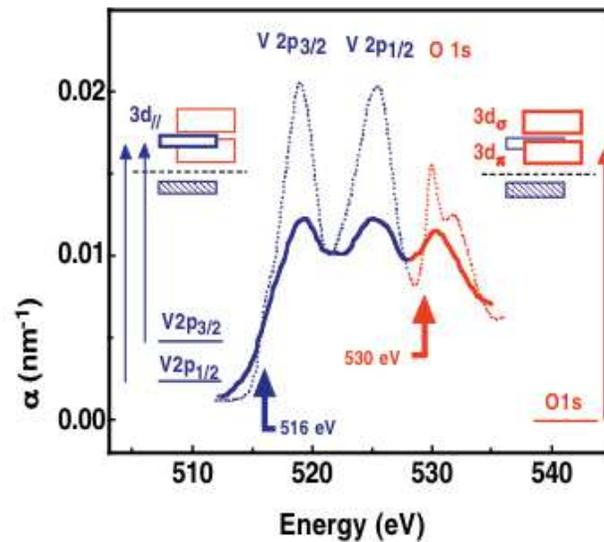
**Figure 5.1** – Coefficient d'absorption du VO<sub>2</sub> obtenu par Cavalleri et al. (2005) pour deux résolutions spectrales différentes : 100 meV (courbe pointillée) et 4 eV (courbe pleine).
