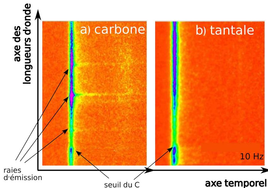
**Figure 5.15** – Spectres d'émission résolus en temps (a) du carbone et (b) du tantale, mesurés à l'aide de la caméra à balayage de fente PX1, corrigés de la courbure induite par la caméra. Ils sont accumulés respectivement sur 3000 et 150 tirs lasers. Le seuil K du carbone, dû au filtre de polyimide, est clairement visible sur les deux spectres.
