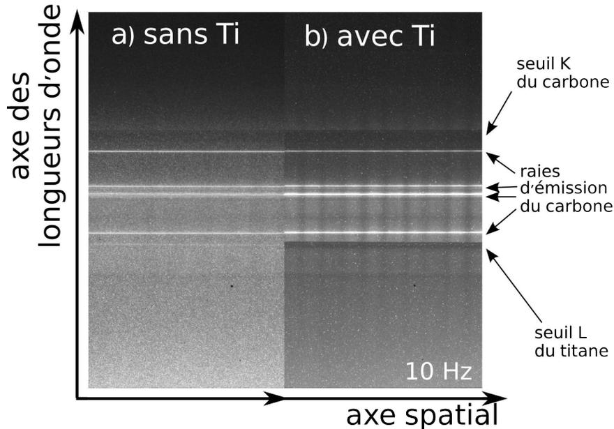
**Figure 5.10** – Spectre intégré en temps émis par un plasma de carbone. a) spectre obtenu avec un filtre composé de 102,7 nm d'Al déposé sur 114 nm de polyimide, plus une protection d'un filtre de 117,3 nm de polyimide. b) spectre obtenu avec un filtre supplémentaire composé de 160 nm de titane et 118,2 nm de polyimide. 1500 tirs lasers ont été accumulés pour chaque mesure.
