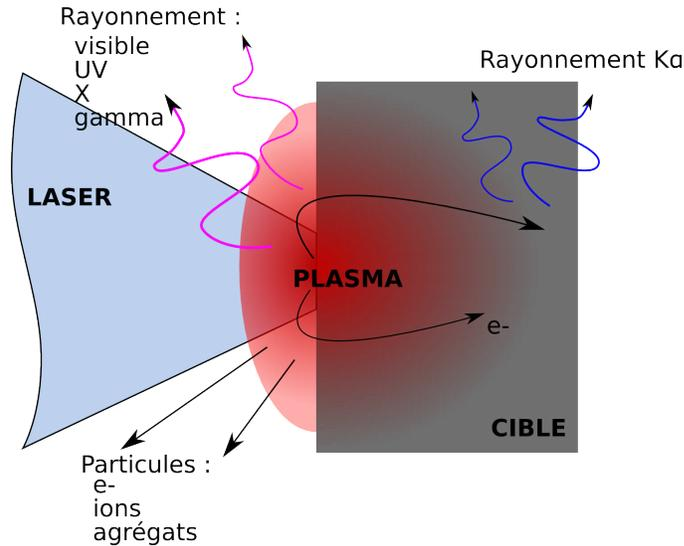
**Figure 1.1** – Principaux mécanismes durant l'interaction laser-matière : émission de rayonnement et éjection de particules.
