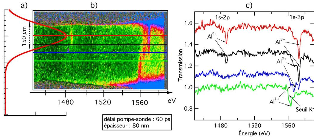
**Figure 4.13** – Transmission expérimentale d'un spectre d'absorption d'une feuille d'aluminium d'épaisseur 80 nm, 60 ps après l'impulsion laser de chauffage. (a) représente la coupe correspondant à la tache focale du faisceau de chauffage, (b) le spectre brut, et (c) les 4 coupes correspondant aux 4 positions, soit 4 intensités lasers différentes.
