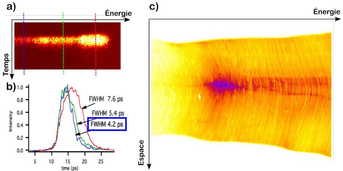
**Figure 4.5** – a) Spectre brut de l'émission d'un plasma de samarium réolué spectralement et temporellement, pour 3 épaisseurs de filtres différents. b) 3 coupes le long de l'axe temporel pour les 3 épaisseurs de filtres. c) Spectre brut résolu spatialement et spectralement, obtenu lors de notre campagne expérimentale.
