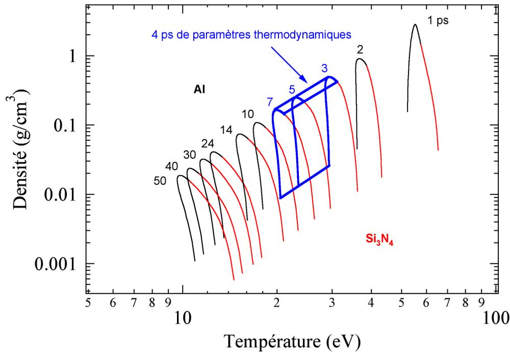
**Figure 4.11** – Couples de densité-température le long du plasma calculés par MULTI-FS pour une feuille d'aluminium de 70 nm d'épaisseur. La partie en rouge correspond à l'épaisseur de nitrure de silicium ne contribuant pas à l'absorption de rayonnement X. La zone en bleu représente l'intégration temporelle, due à la durée de la sonde de rayonnement X (4 ps).
