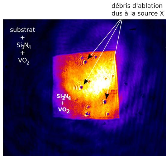
**Figure 5.7** – Membrane carré d'environ 2 mm<sup>2</sup> composée de 200 nm de Si<sub>3</sub>N<sub>4</sub> et de 130 nm de VO<sub>2</sub>, ouverte dans le substrat de silicium.
