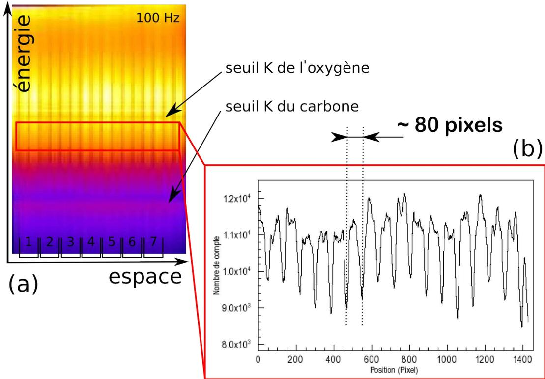
**Figure 5.12** – Spectre obtenu à partir d'une cible de tantale, présentant les lignes verticales dues à l'absorption par la grille de nickel qui est présente sur les filtres d'aluminium en entrée du spectromètre.
