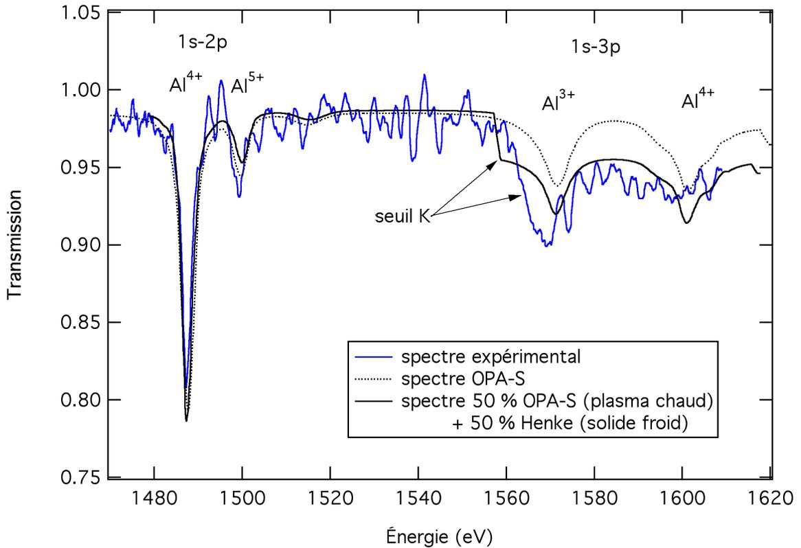
**Figure 4.20** – Spectre expérimental (bleu), obtenu pour une intensité laser de  $3 \times 10^{14} \text{ W/cm}^2$  et un délai de 0 ps entre la pompe et la sonde, et deux spectres théoriques (noirs). La courbe en pointillée présente une simulation OPA-S avec une densité et une température moyenne. La courbe pleine est un mélange de spectre froid (table de Henke) et d'une simulation OPA-S.
