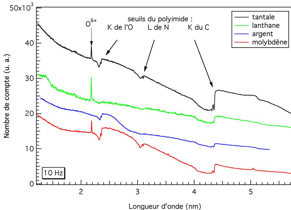
**Figure 5.14** – Spectre de rayonnement X pour différents éléments : le molybdène ( $Z=42$ ), l'argent ( $Z=47$ ), le lanthane ( $Z=57$ ) et le tantale ( $Z=73$ ).
