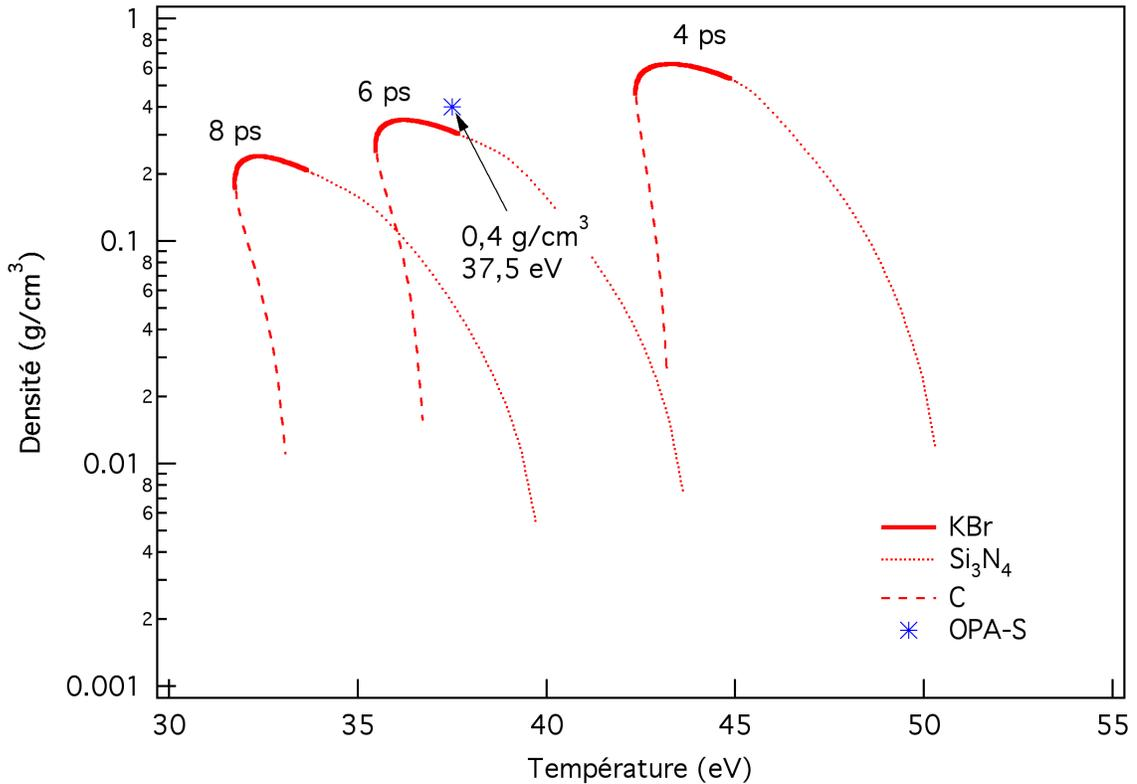
**Figure 4.24** – Couples de densité-température le long de l'axe d'absorption de rayonnement X pour différents temps, centrés sur 6 ps ( $\pm 2$  ps) du plasma de KBr. Les parties en tiret correspondent au carbone, celles en pointillées correspondent au nitrure de silicium. Le point bleu correspond à la valeur moyenne, et est utilisé pour réaliser les simulations de la figure 4.25.
