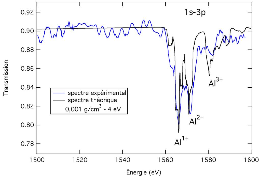
**Figure 4.21** – Spectres d’absorption expérimental (bleu) et théorique (noir) d’un plasma d’aluminium froid et dilué ( $I_{laser} = 3 \times 10^{14}$  W/cm<sup>2</sup>,  $t = t_0 + 52$  ps). Le spectre théorique a été calculé avec une densité 10 fois inférieure à celle prévue par le diagnostic FDI.
