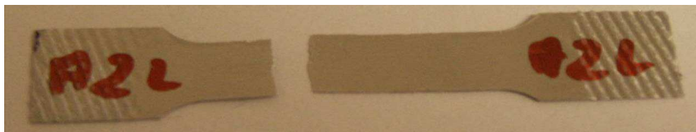
Figure 198 : Rupture d'une éprouvette d'aluminium pur.
