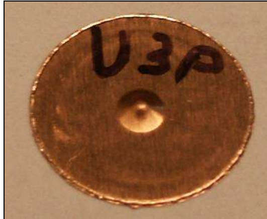
Figure 191 : Echantillon après essai d'Erichsen modifié (zone emboutie au centre).
