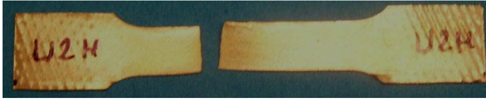
Figure 42 : Rupture à 90° d'une éprouvette de 100µm d'épaisseur.
