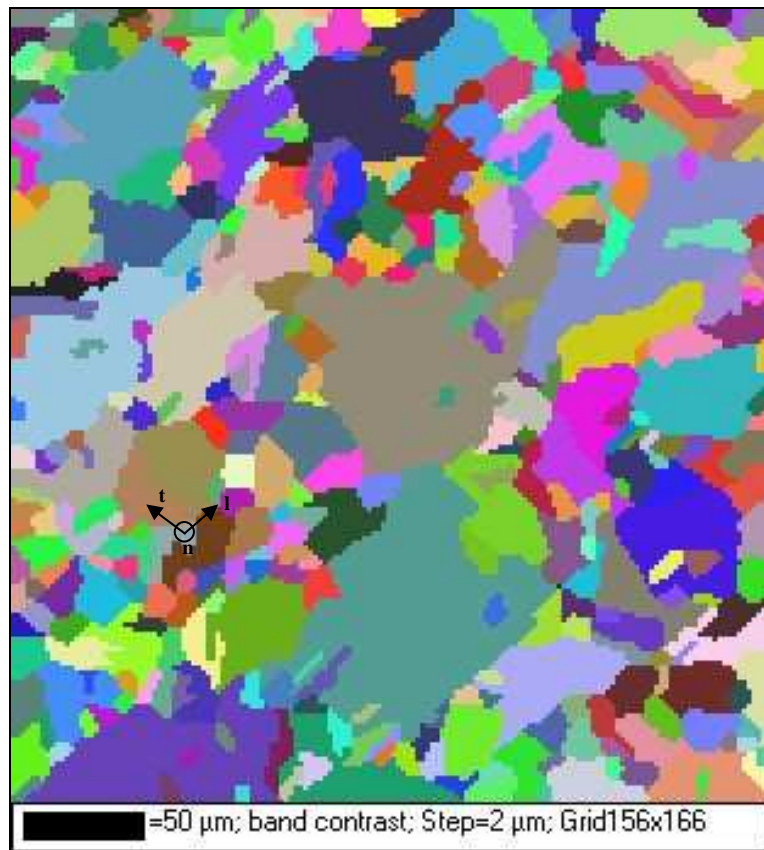
Figure 19 : Cartographie EBSD de la microstructure du cuivre à l'état initial.
