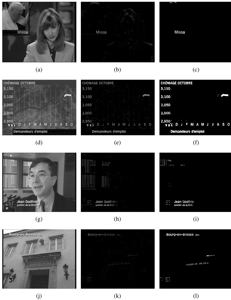
FIG. 5.3: Exemples de détections de texte pour différentes images issues de la base de Demarty [22]. De gauche à droite : image initiale, résultat de l'algorithme, seuillage entropique (cf Pun [69]) de ce résultat.
