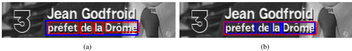
FIG. 4.3: En ligne continue la/les boîte(s) de la vérité terrain, en pointillé la/les boîte(s) détectée(s). Bien que dans les deux cas (a) et (b) le résultat de la détection soit perceptuellement correct, on dépend de la granularité de la vérité terrain. Dans les deux cas on obtient un mauvais score de localisation.
