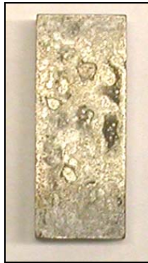
Figure 2.29 : Détail de surface d'une barre de matériau fer-diélectrique après recuit à 450 °C
